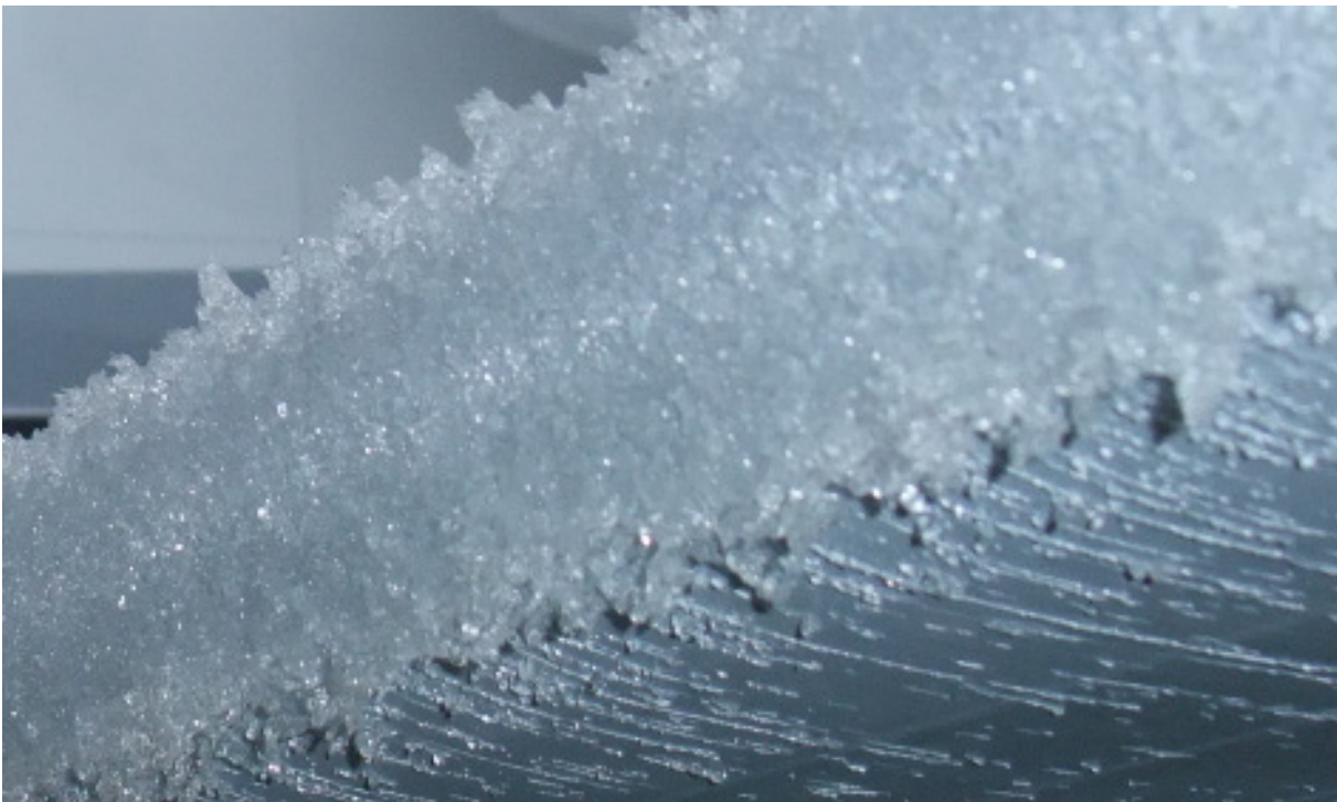
Abb. 6: Detailaufnahme der Form des Eisansatzes an der Vorderkante der Tragfläche
