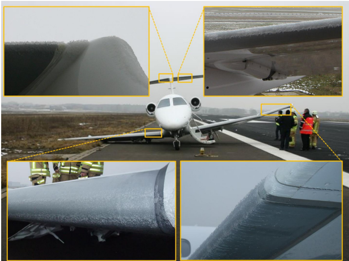
Abb. 9: Eisansatz an Höhenleitwerk und Tragflächenvorderkanten
