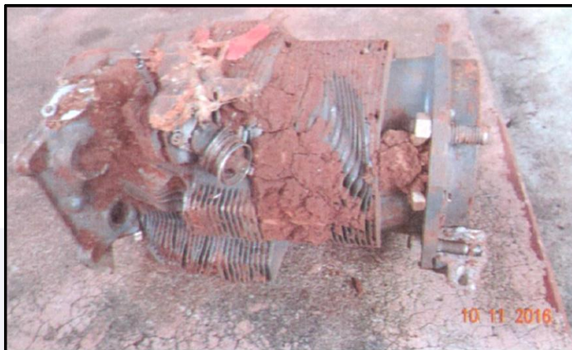
Figura 11 - Cilindro nº 2 arrancado do motor.
