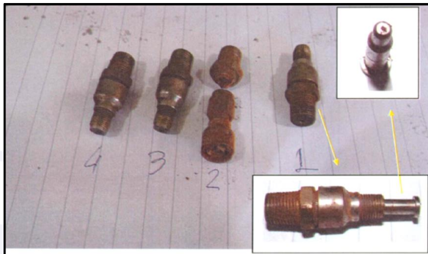
Figura 5 - Vista geral dos injetores de combustível do motor. No detalhe é mostrado o injetor do cilindro nº 1 que estava obstruído por terra, consequência do acidente.
