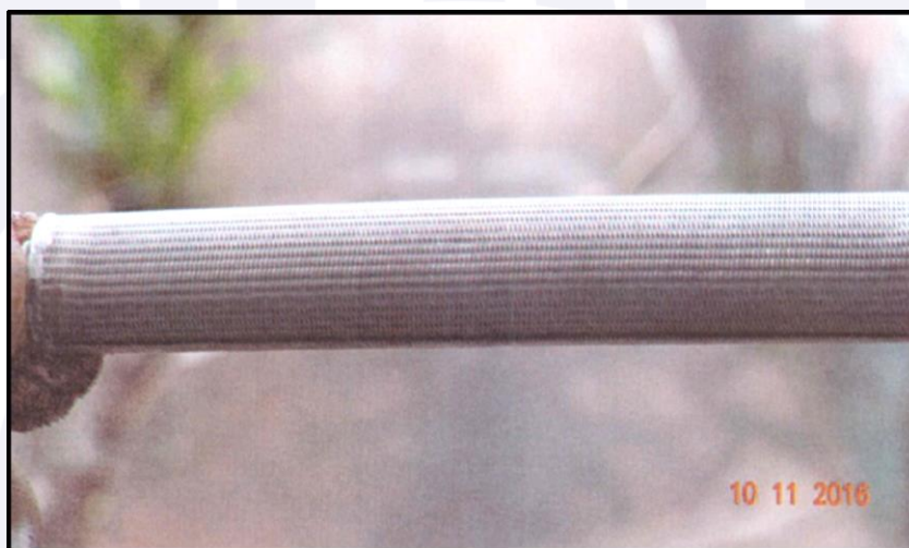
Figura 9 - Filtro de entrada de combustível da servoinjetora limpo.
