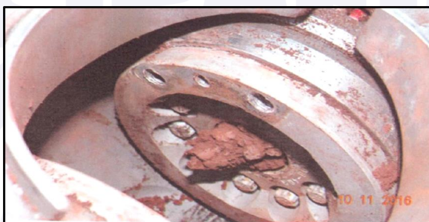
Figura 14 - Mecanismo de mudança de passo da hélice quebrado.
