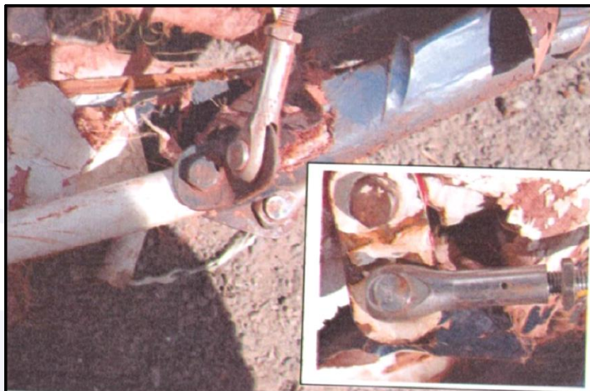
Figura 15 - Comandos da aeronave sem evidência de falhas.
