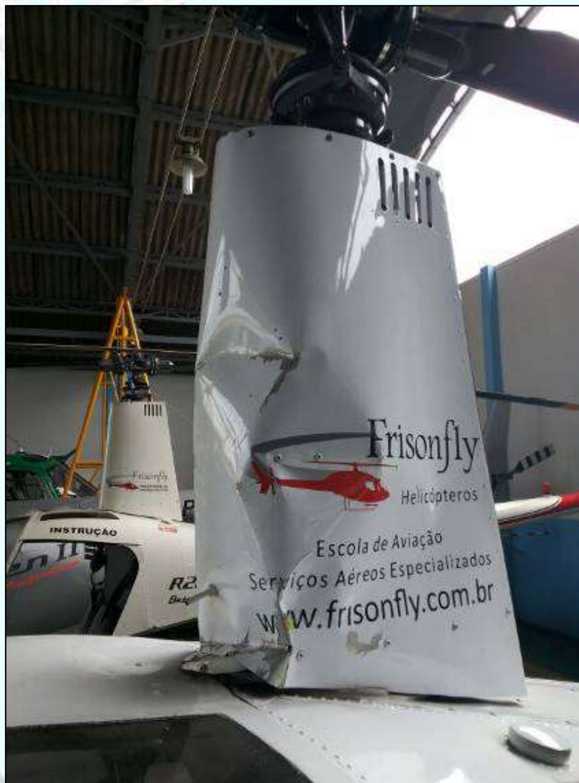
Figura 1 - Danos na carenagem do mastro.
