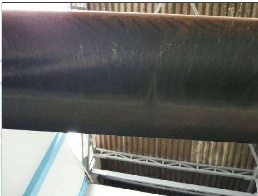
Figura 2 - Danos na pá do rotor principal.
