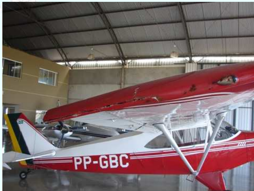
Figura 1 - Danos à ponta da asa direita da aeronave.
