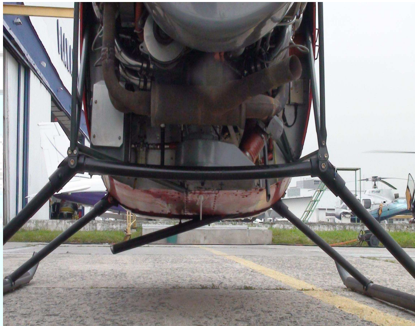
Figura 1 - Danos causados à estrutura dos esquis.
