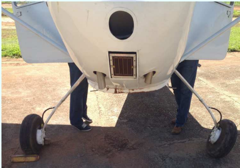
Figura 01 - Situação do trem de pouso após a ocorrência.
