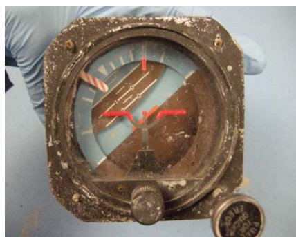
Figure 7- Standby ADI P/N: 504-0017-901, S/N: 3942
