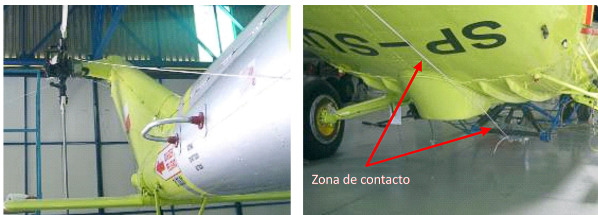
Figura 10. Fotografías de la cuerda uniendo el gancho de carga y el rotor de cola en un helicóptero del mismo modelo que el accidentado
