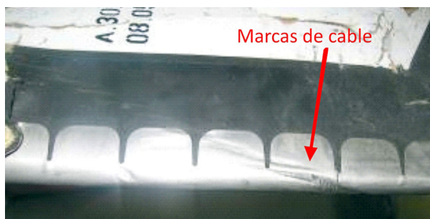
Figura 7. Marcas de cable en borde de ataque de pala de rotor de cola
