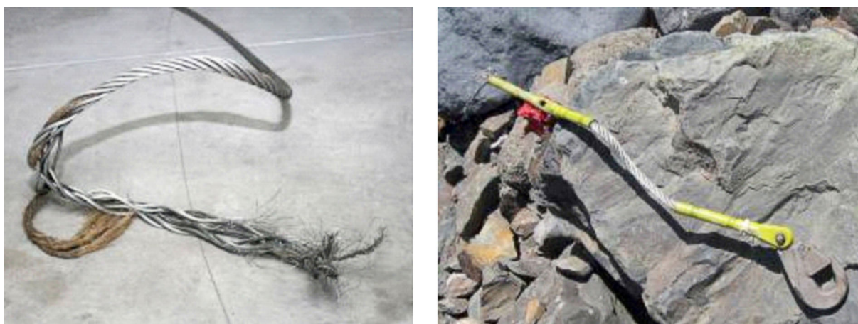
Figura 9. Fotografías de la zona de rotura del cable. Parte superior a la izquierda e inferior a la derecha
