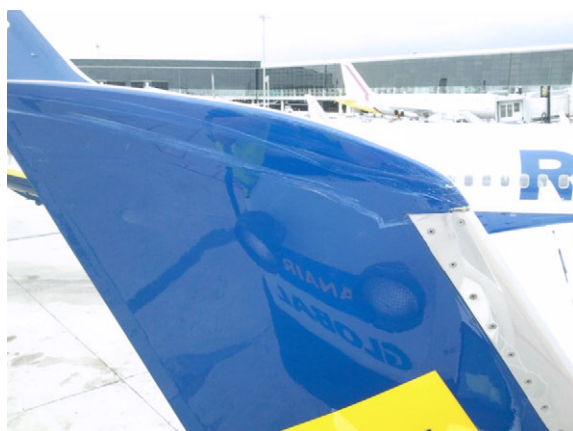
Figura 1. Daños en el winglet del B737
