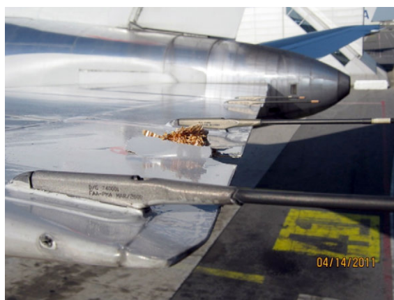
Figura 2. Daños en el estabilizador del B767
