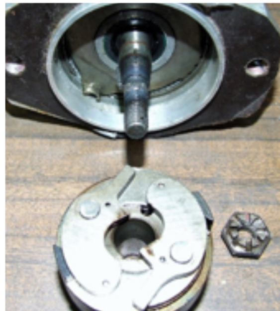
Fotografía 5. Desmontaje "Impulse Coupling"
