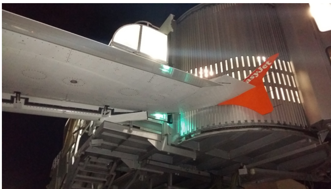
Figura 3. Daños de la aeronave e infraestructuras aeroportuarias
