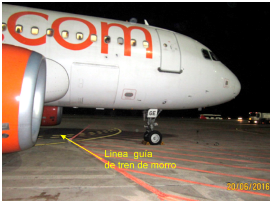
Figura 5. Detalle de desviación de la trayectoria
