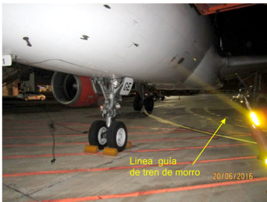
Figura 4. Alineamiento de las ruedas del tren de morro
