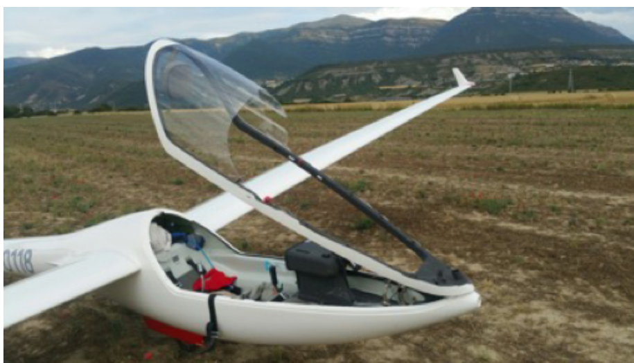
Figura 1. Daños en la cúpula del planeador
