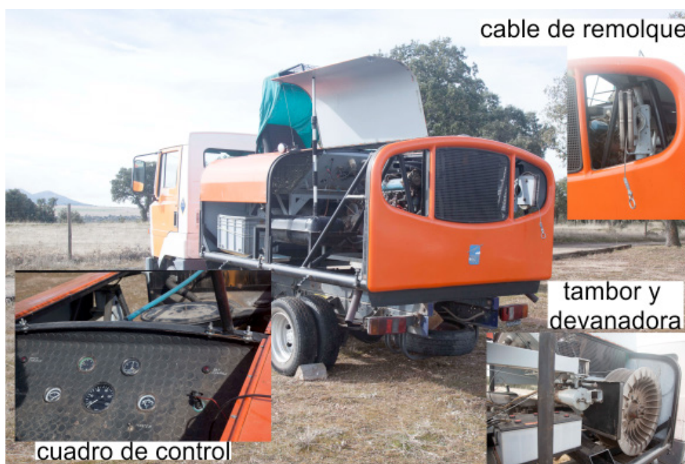
Fotografía 2. Torno Tost BB280 de remolque de veleros
