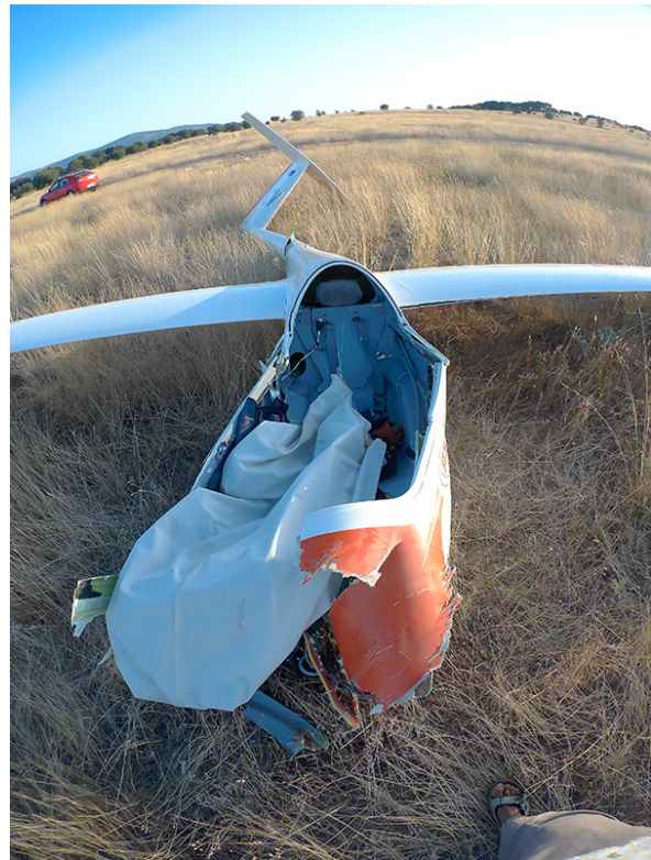
Fotografía 3. Daños en el velero
