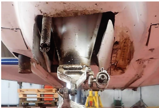
Fotografía 6. Compuertas del tren de morro
