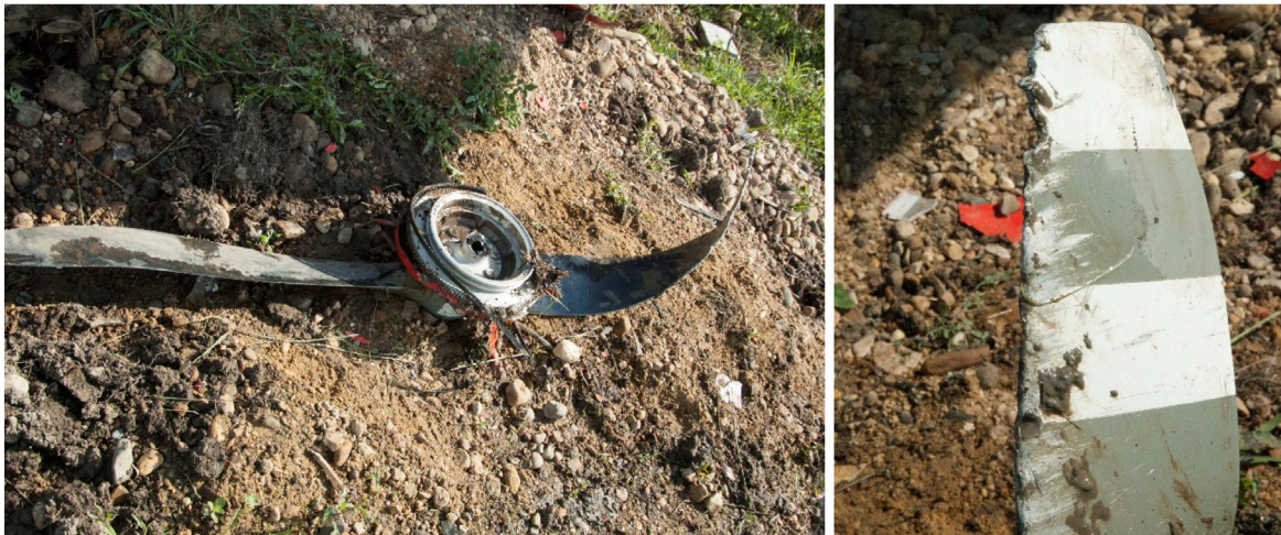
Figura 7. Fotografía general de la hélice (izquierda) y detalle del extradós de una de las palas (derecha)
