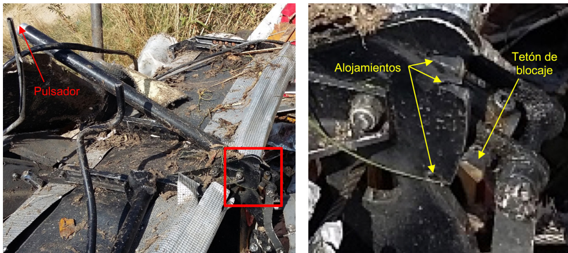
Figura 6. Fotografía de la palanca de flap (izquierda). A la derecha ampliación de la zona recuadrada en rojo en la fotografía de la izquierda, para mejorar la visualización del tetón de bloqueo y los tres alojamientos del mando
