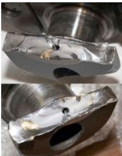
Figura 9. Detalle de la rotura del cigüeñal
