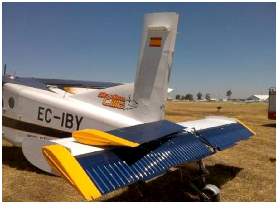
Figura 1. Estado del empenaje de cola tras el aterrizaje
