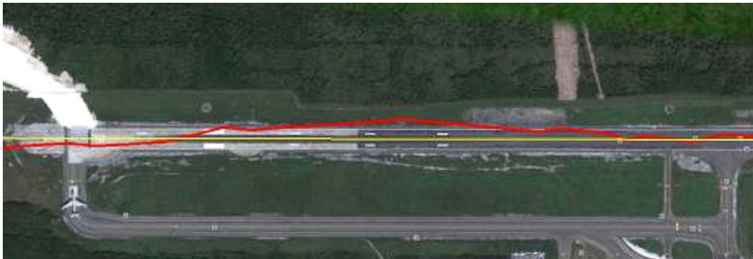
Figura 15. Representación de la trayectoria seguida fuera de pista por la aeronave
