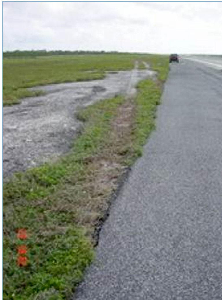
Figura 2. Huellas del tren principal de aterrizaje izquierdo
