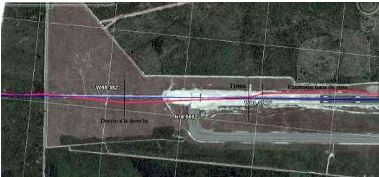
Figura 13. Representación de la trayectoria de aproximación y toma según coordenadas grabadas
