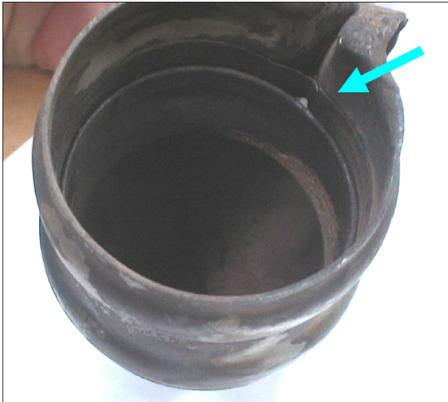
Figura 6. Los labios de la pestaña flexible interna están en contacto y se han deformado debido al par de apriete aplicado a las orejetas
