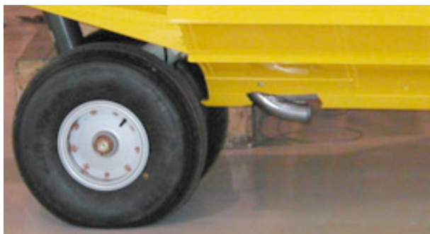
Figura 2. Detalle de una toma de agua
