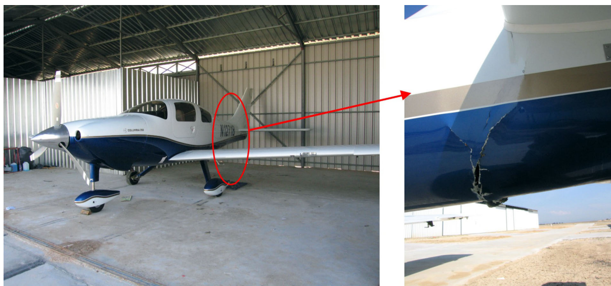
Figura 1. Detalle de los daños apreciables en el carenado de la rueda derecha y en la cola
