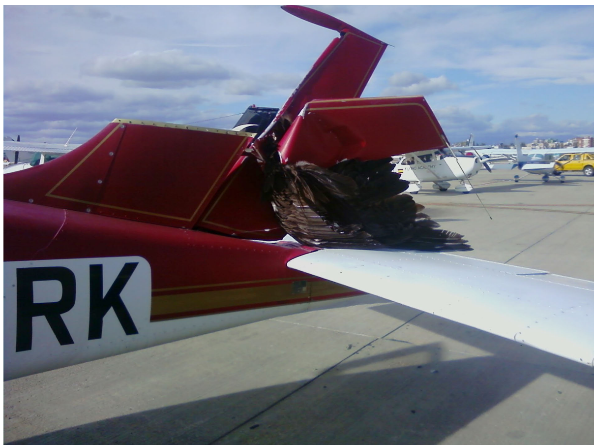
Figura 2. Fotografía del avión con el buitre en la cola
