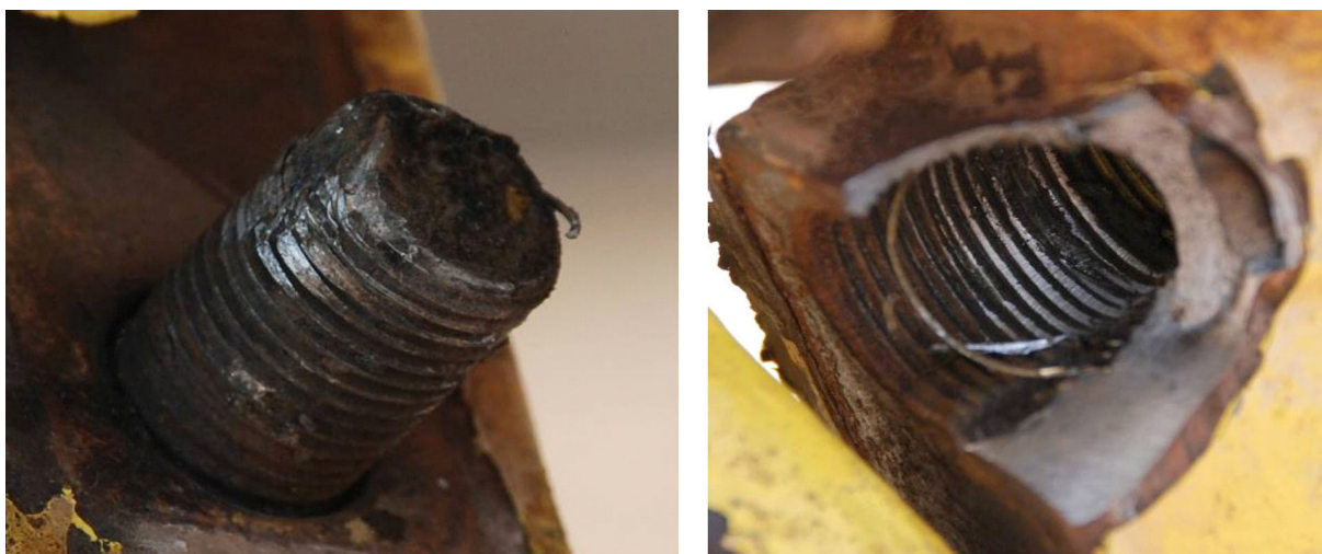
Figura 4. Detalles del tornillo trasero y de su alojamiento
