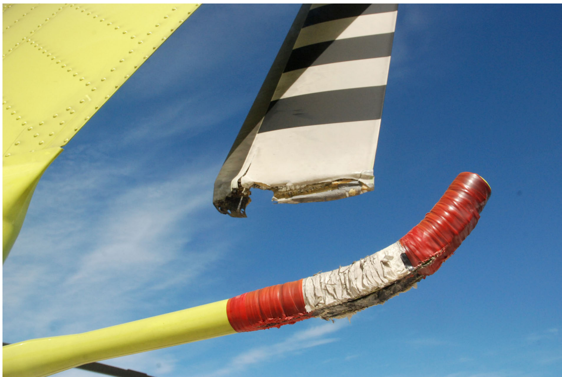
Figura 2. Daños en protector y rotor de cola.
