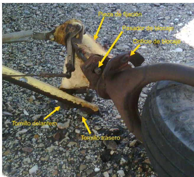
Figura 3. Detalle del patín de cola
