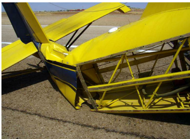
Figura 1. Fotografía de la zona de rotura del fuselaje de cola
