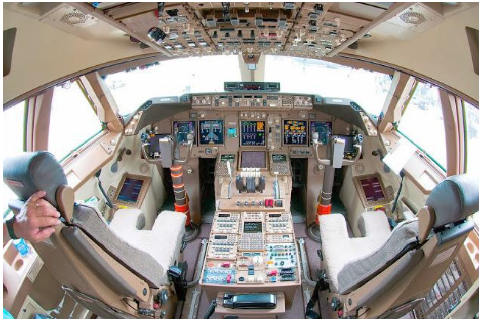
Mandos de Boeing 747, nótese el tipo de timones iguales y sincronizados (Commons.wikipedia.org).
