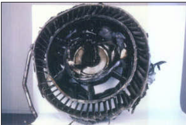
Cliché 6 : Moteur Gauche CF 700-2D - S/N 304454B, Partie arrière désolidarisée
