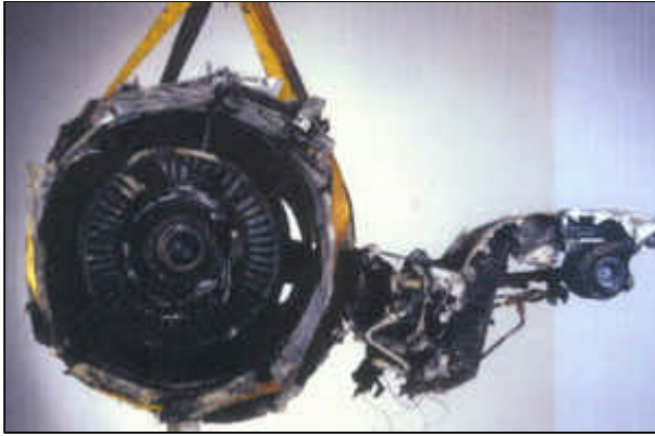
Cliché 4 : Moteur Gauche CF 700-2D - S/N 304454B, Arrière désolidarisé du distributeur du disque de soufflante
