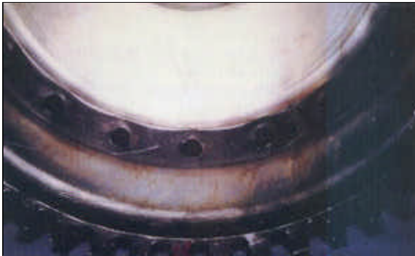
Cliché 9 : Moteur Gauche CF 700-2D - S/N 304454B, Déformation de la jante et des trous de fixation
