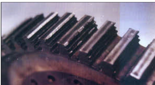
Cliché 7 : Moteur Gauche CF 700-2D - S/N 304454B, Détail des arrachements des logements des pieds d'aubes
