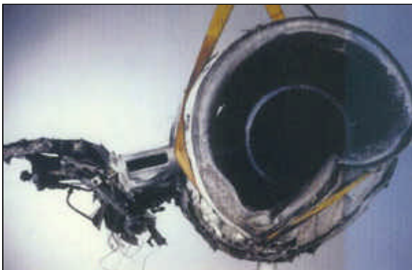
Cliché 3 : Moteur Gauche CF 700-2D - S/N 304454B, Entrée d'air et nacelle
