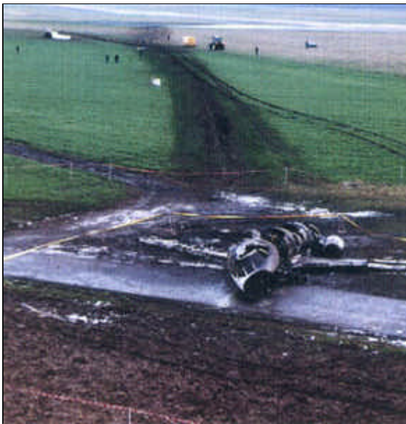
Cliché 2 : L'épave principale. On distingue nettement la trajectoire sol de l'avion par ses traces sur l'herbe
