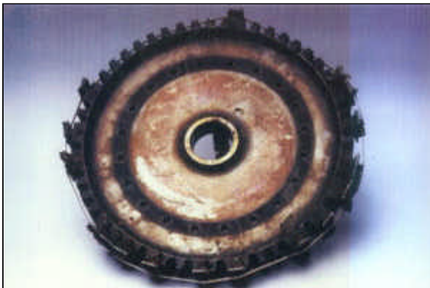
Cliché 5 : Moteur Gauche CF 700-2D - S/N 304454B, Etat du disque de soufflante sur le site, avec 18 pieds d'aubes
