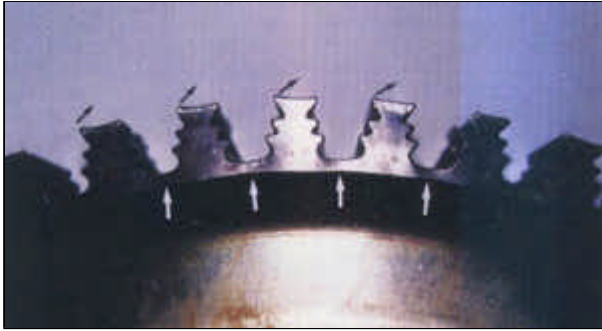
Cliché 8 : Moteur Gauche CF 700-2D - S/N 304454B, Déformation du lobe extérieur et de la jante
