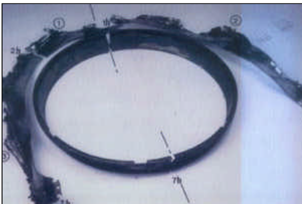
Cliché 11 : Moteur Gauche CF 700-2D - S/N 304454B, Anneau de rétention reconstitué, vu de l'avant, avec celui du moteur droit
