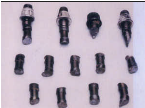
Cliché 13 : Moteur Gauche CF 700-2D - S/N 304454B, Boulons de fixation des deux demi-arbres sur le disque
