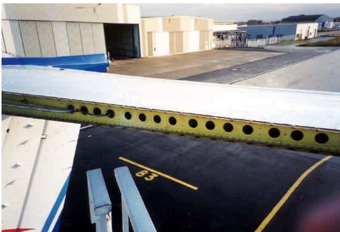
Photographie n° 4 : Détail du bord d'attaque de l'empennage arrière gauche
