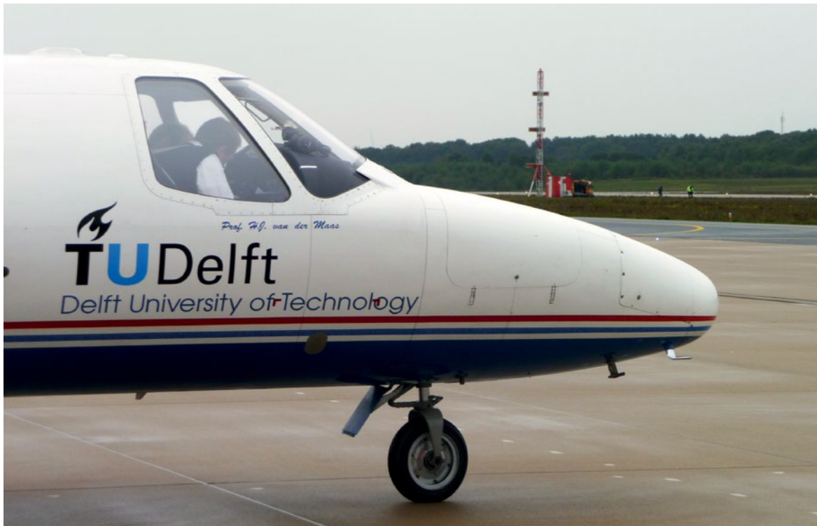
Figuur 14: Cessna Citation II aan de grond op Vliegbasis Woensdrecht, met op de achtergrond de M-array ILS-glijpadantenne.
