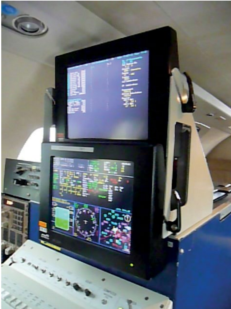
Figuur 2: Het FIS (Flight Inspection System) aan boord van het PH-LAB.
