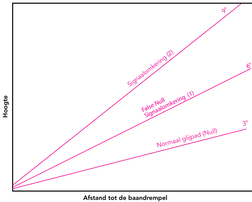
Figuur 23: Dwarsdoorsnede gemeten glijpadveld (2); eerste signaalomkering (1) bij het 6-graden glijpad (Null Reference en M-array).
