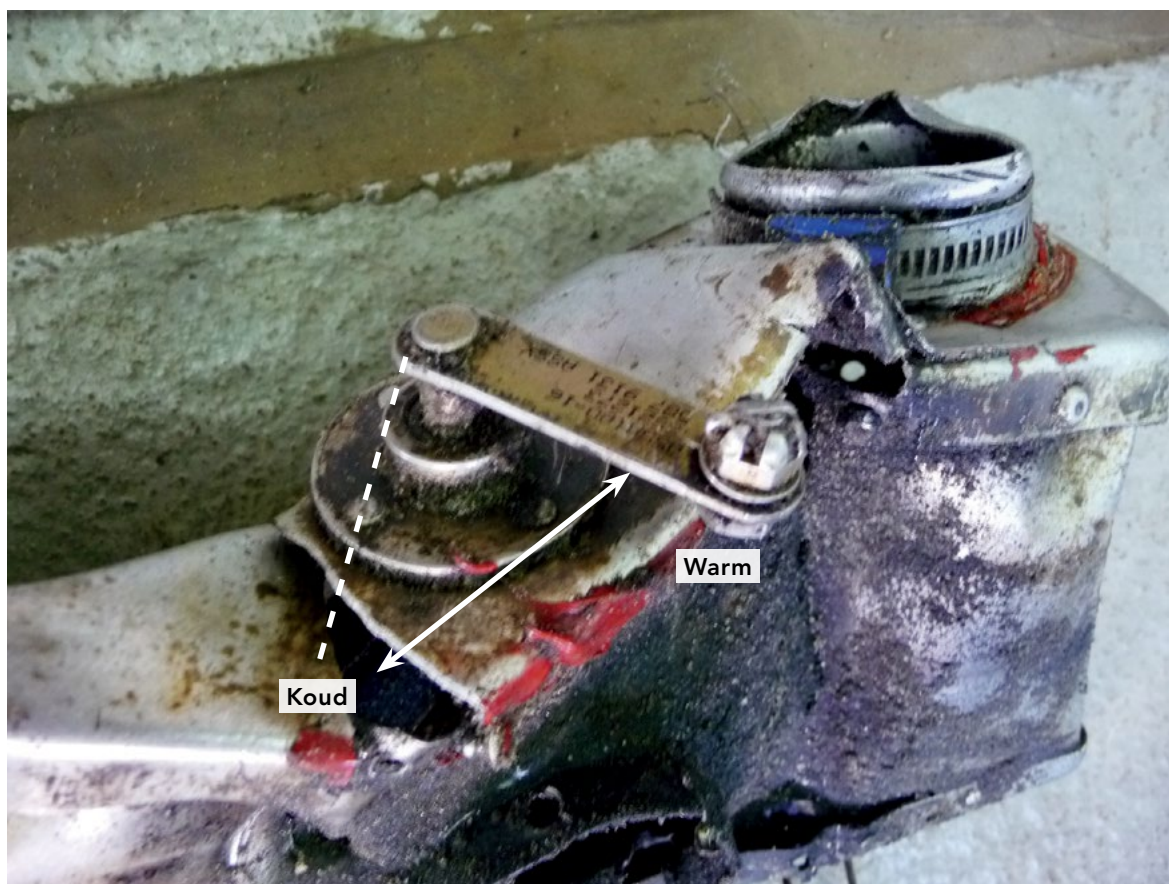
Figuur 6: Luchtinlaat met klep en bedieningshefboom in de stand 'WARM'
