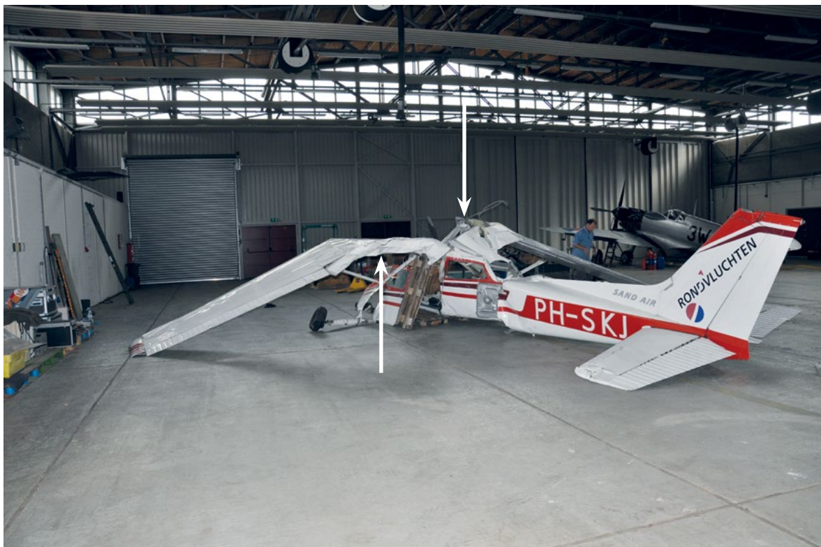
Figuur 2: Vervorming van de vleugel-rompconstructie
