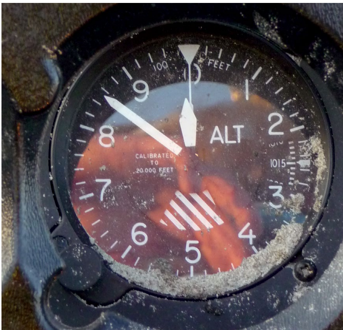
Figuur 5: Hoogtemeter, ingesteld op 1015 hPa
