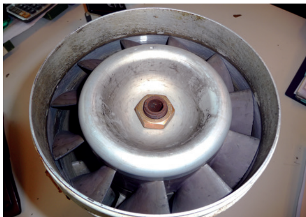
De recirculatiepomp met aan de binnenzijde aanloopsporen van de schoepen
