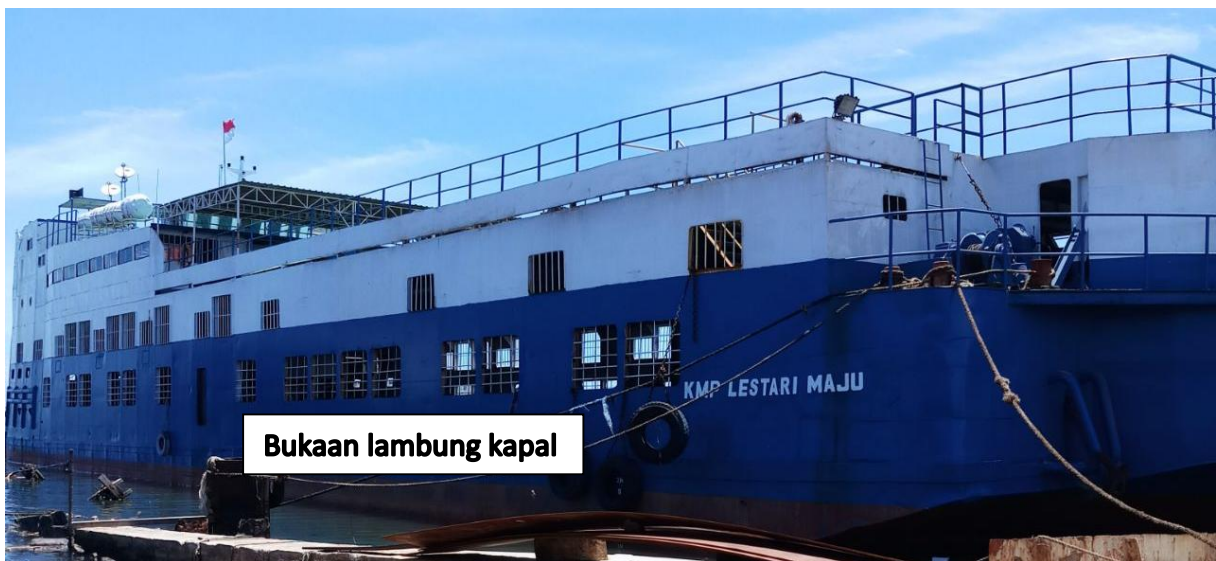
Gambar II-1: Bukaan yang ada pada sisi lambung Lestari Maju sepanjang badan kapal
