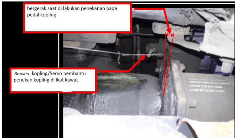
Gambar 23. Silinder penggerak/penekan kopling dalam kondisi tidak terpasang dengan benar dan ditemukan terikat kawat.
