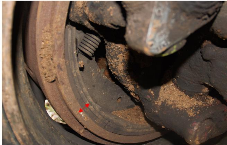
Gambar 17. Kampas rem roda depan masih tebal dan celah antara kampas rem dengan permukaan dalam tromol kanan 0,5 mm - kiri 1,7 mm.
