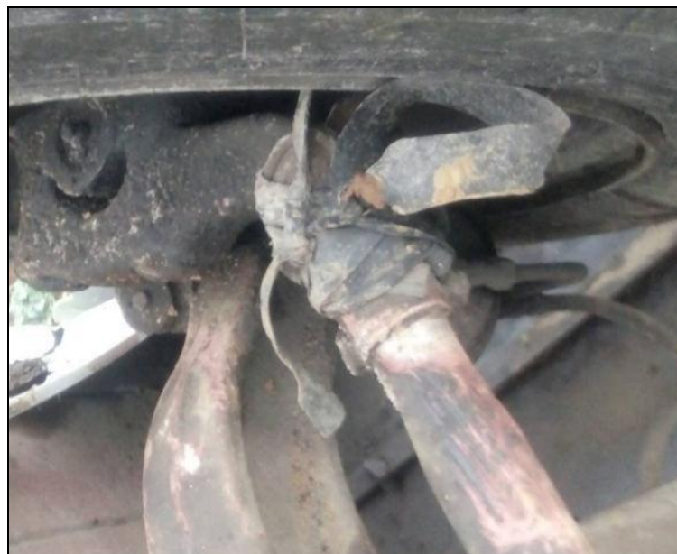
Gambar 20. Tierod end kiri-kanan diikat karet ban dalam
