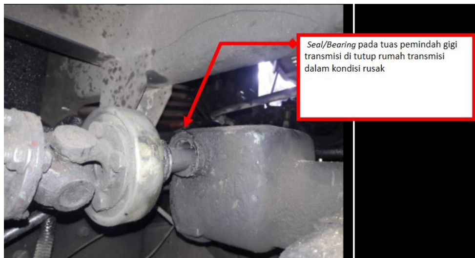
Gambar 22. Seal/bearing pada tuas pemindah gigi transmisi di tutup rumah transmisi dalam kondisi rusak lama.
