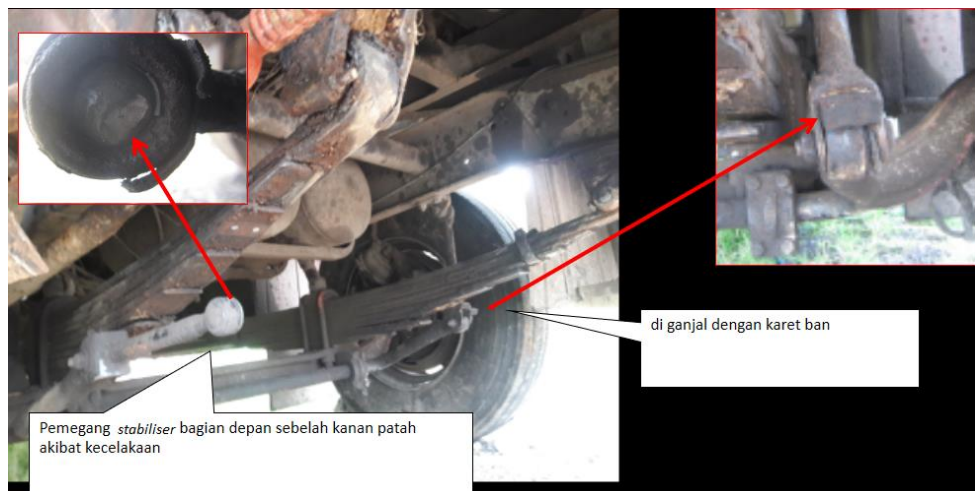
Gambar 21. Pegangan stabiliser bagian depan sebelah kiri terlihat diganjal dengan karet ban dan sebelah kanan patah.
