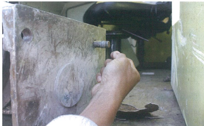
Gambar 4. Baut tread break housing yang ulirnya dililit kawat
