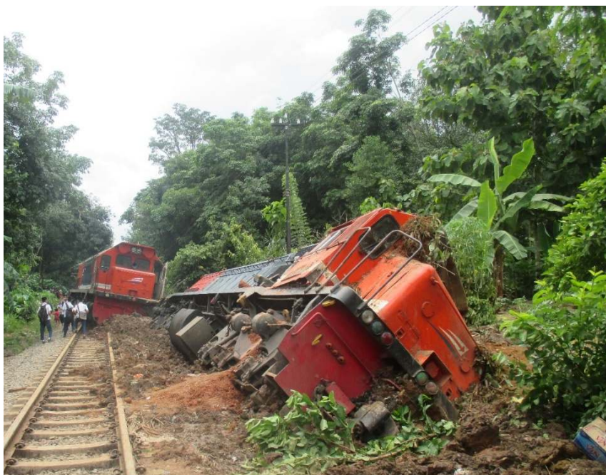
Gambar 1. Kondisi kereta KA 3008 setelah anjlokkan.
