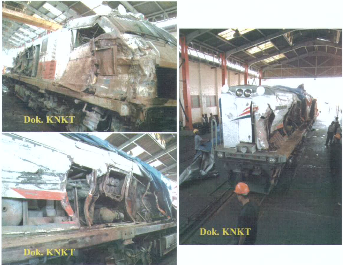
Gambar 2. Lokomotif CC 2039816 rusak berat pada sisi kanan ujung pendek
