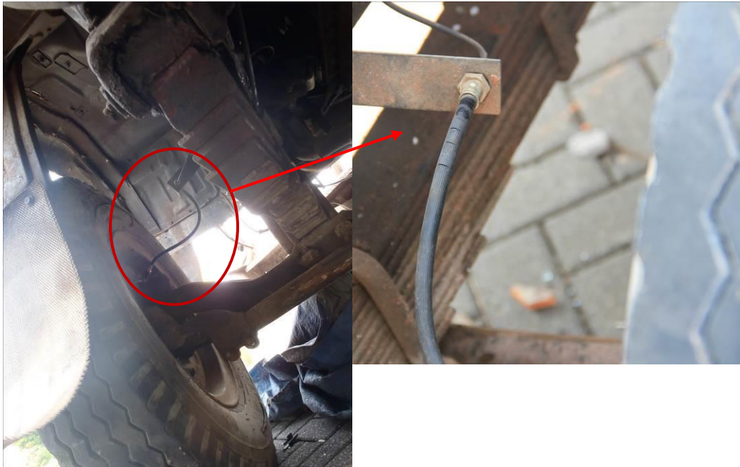
Gambar 3. Kondisi rubber flexible hose sylinder brake di sumbu depan kiri sudah menua dan mengalami kebocoran.
