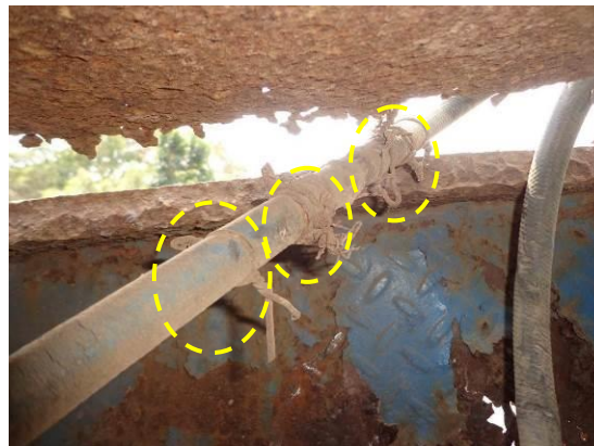
Gambar 9. Pengikat pada selang fleksibel kereta tempelan.
