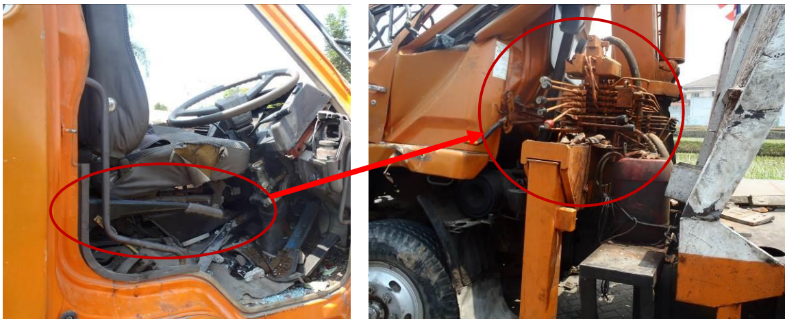
Gambar 4. Handbrake berubah fungsi menjadi tuas gerak hydraulic crane .
