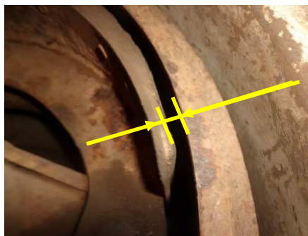
Gambar 9. Celah kanvas rem dan tromol roda sumbu 4 kereta tempelan.
