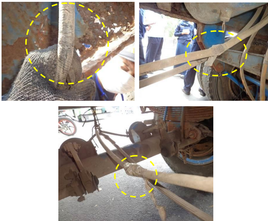
Gambar 7. Kondisi selang fleksibel rem kereta tempelan.
