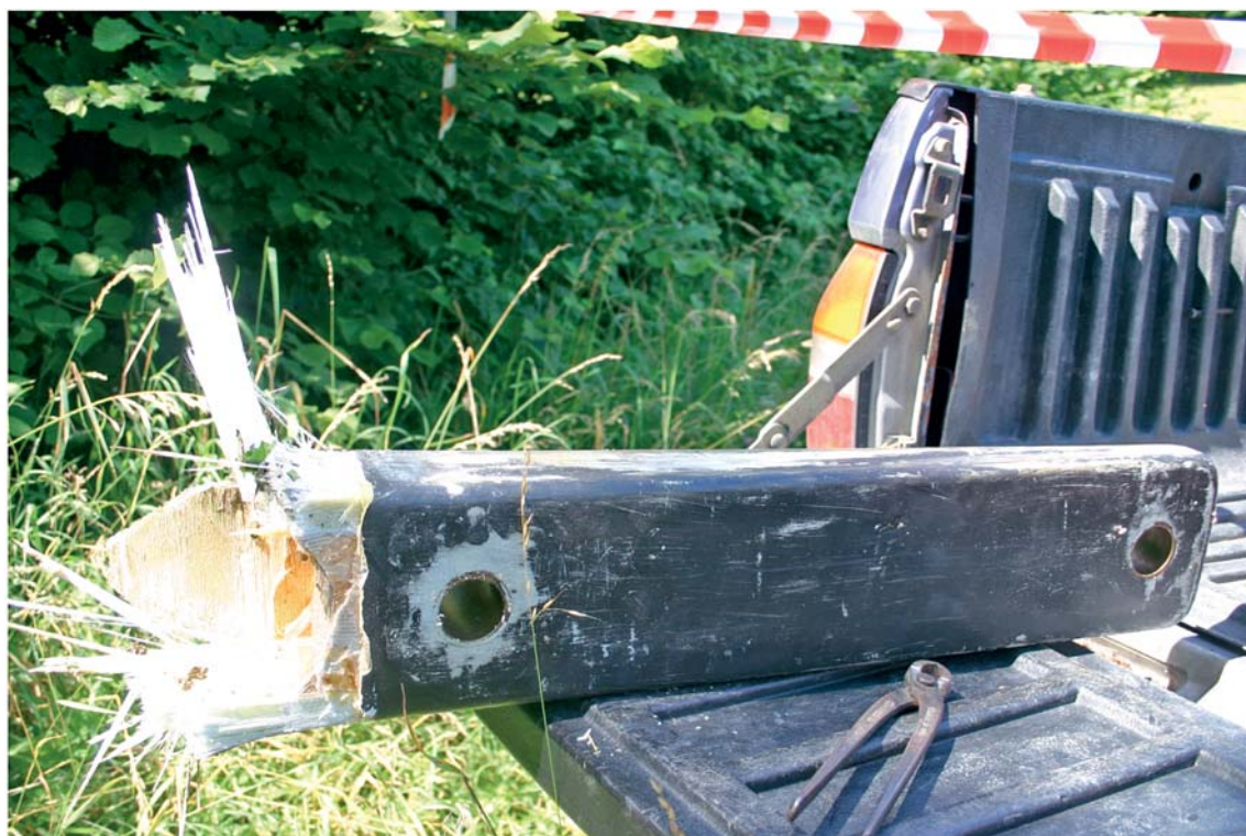
Estremità del longherone sinistro rimasto in fusoliera.
