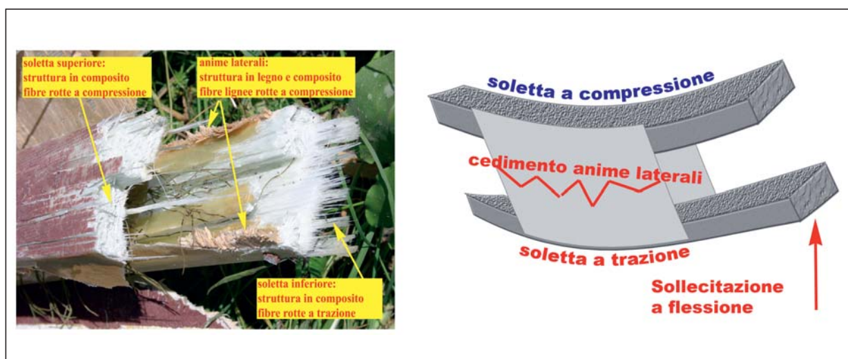
Fig. n. 6: sezioni di rottura delle "solette" e dinamica di cedimento delle "anime".
