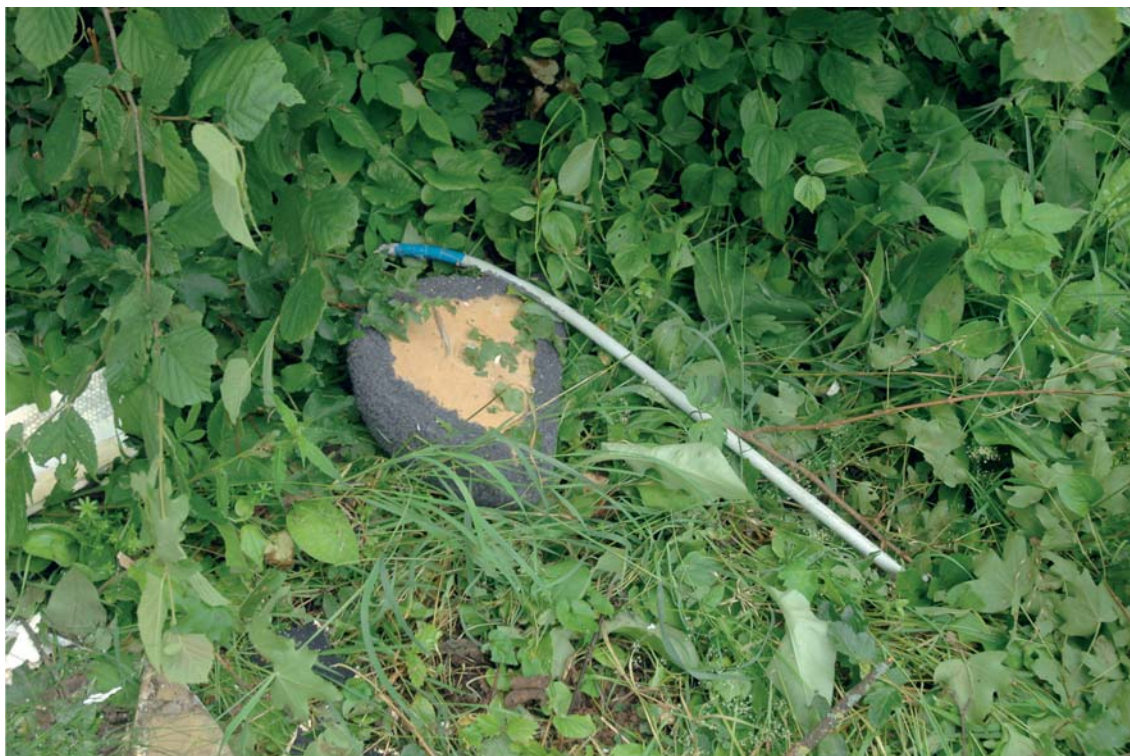
Asta comando alettone semiala sinistra distaccato da fusoliera e semiala.
