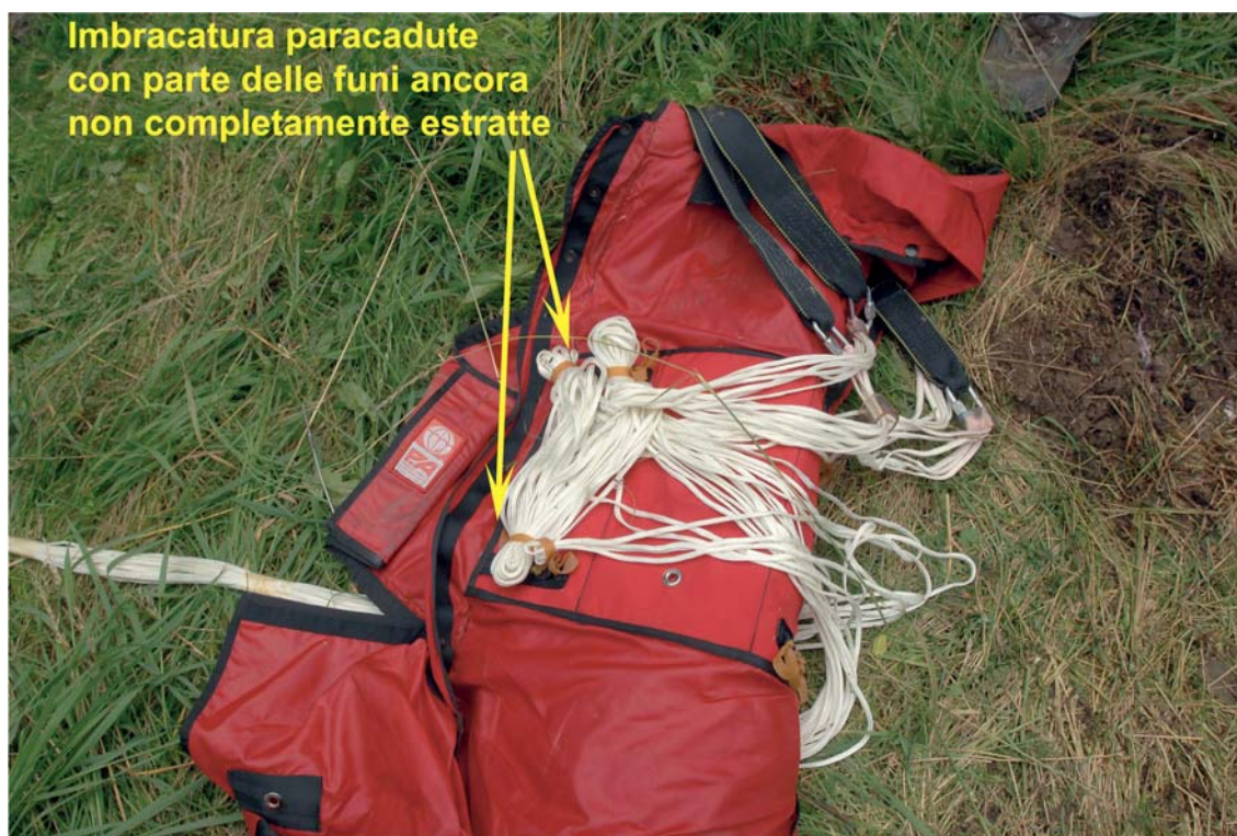
Particolare imbracatura e funi non ancora completamente estratte.
