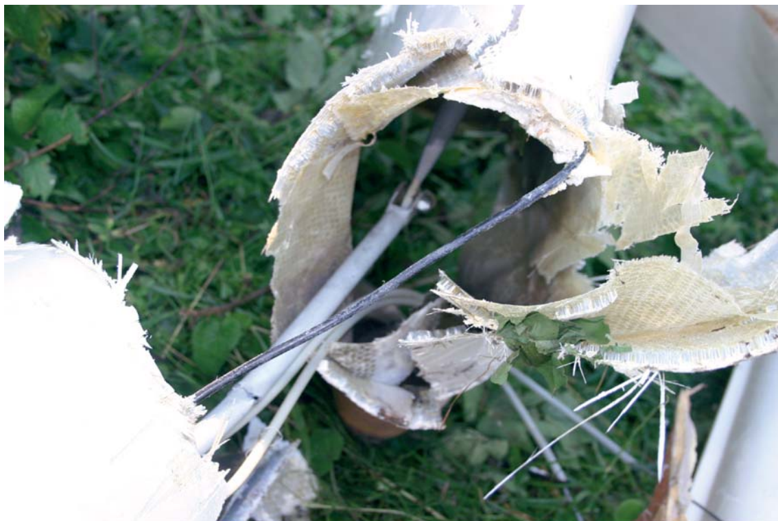
Rottura sezione di coda - vista cinematismi superfici mobili impennaggi.
