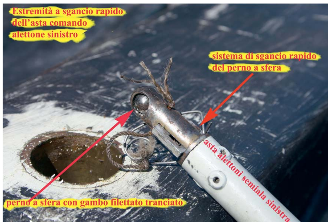
Estremità sgancio rapido in fusoliera asta comando alettone semiala sinistra.
