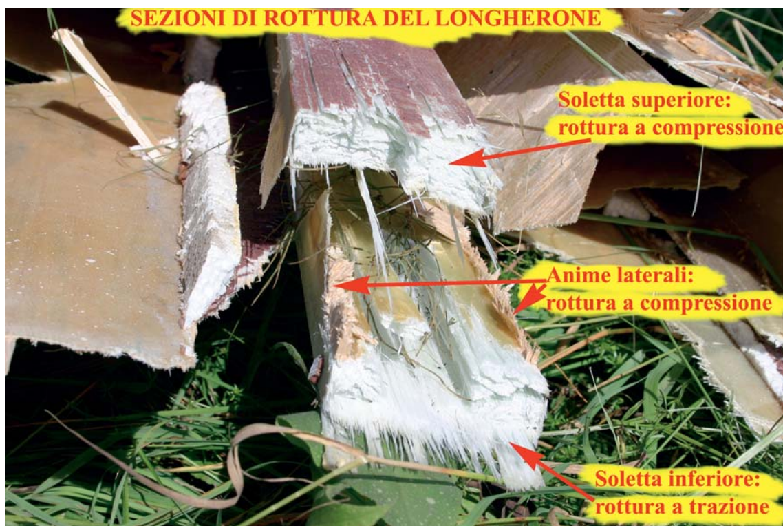
Particolare delle sezioni di rottura del longherone.
