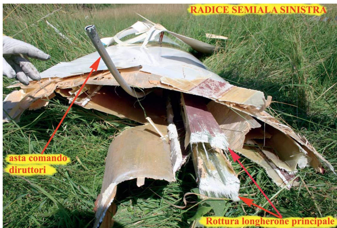
Rotture della struttura alla radice della semiala sinistra.
