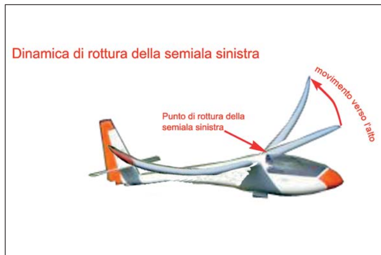
Fig. n. 3: movimento di distacco della semiala sinistra.
