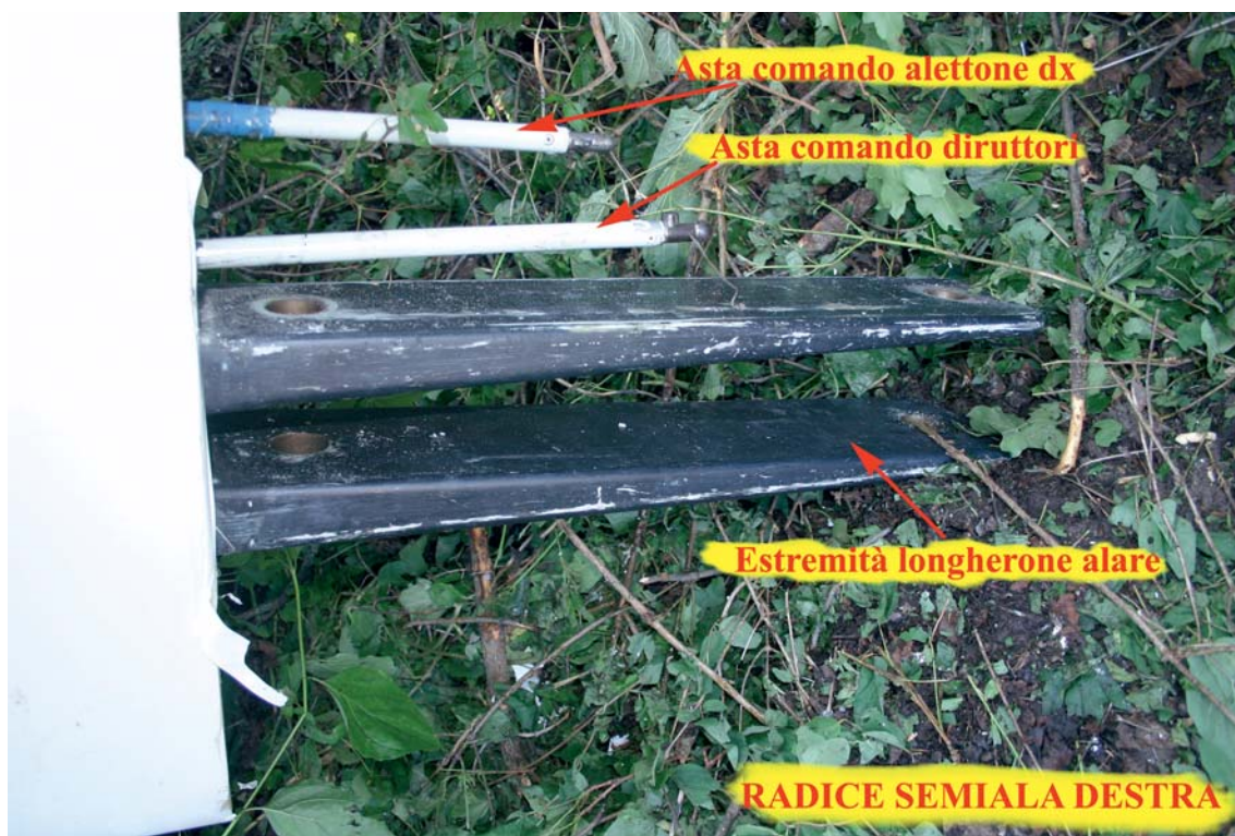
Radice ed estremità longherone semiala destra dopo rimozione dalla fusoliera.
