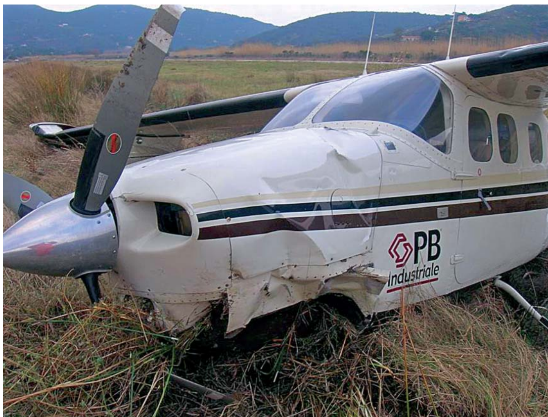
Dettaglio danni fusoliera anteriore.
