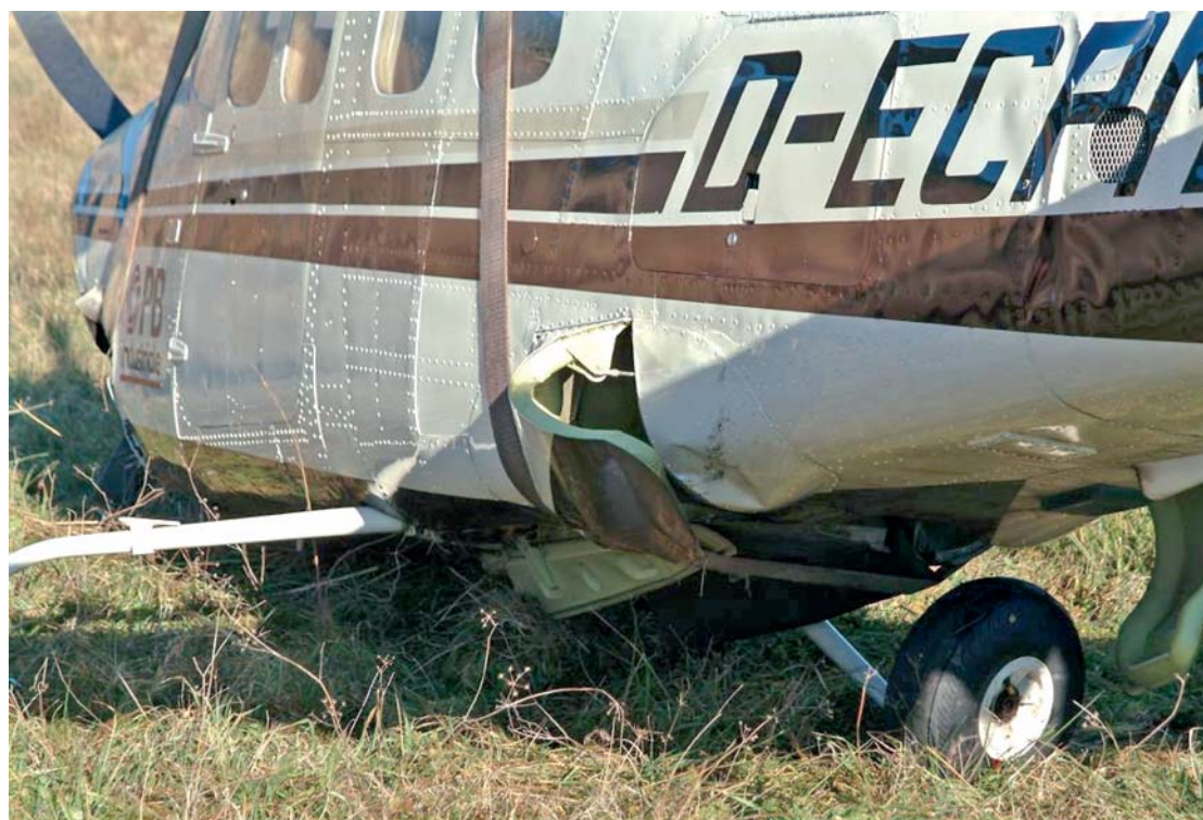
Dettaglio danni fusoliera posteriore e portello apertura carrello sinistro.
