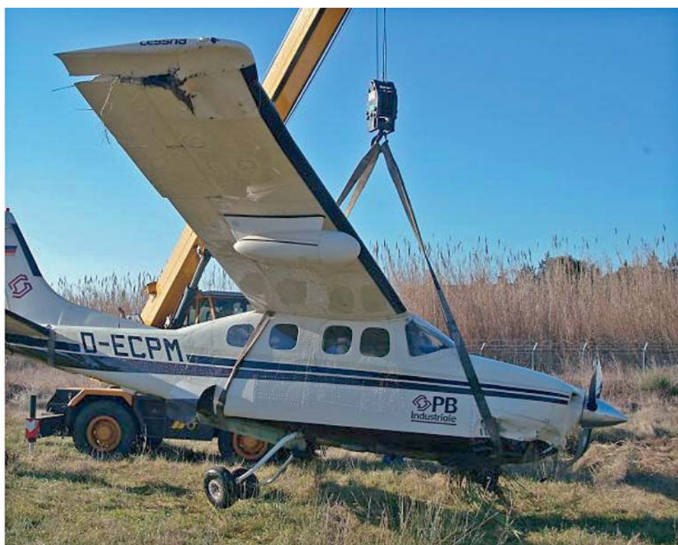
Dettaglio danni estremità alare destra.
