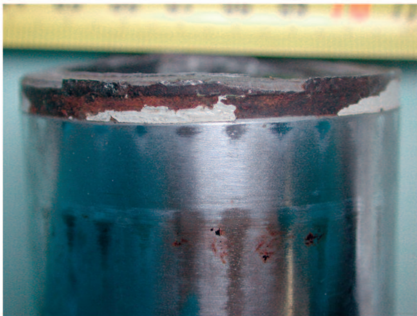
Figura 7– corrosione generalizzata della superficie esterna in corrispondenza della zona d'innescio
