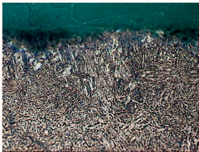
Figura 22 – Microstruttura in corrispondenza della superficie di rottura, in prossimità della zona di innesco (x500)
