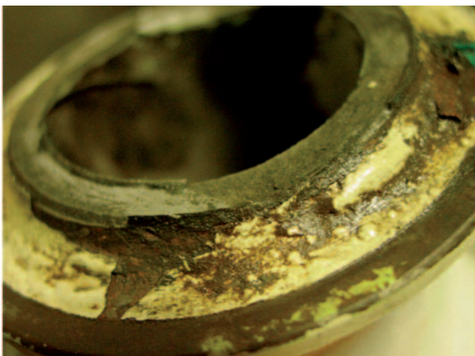
Foto n. 6: corrosione a carico della superficie esterna dell'assale.
