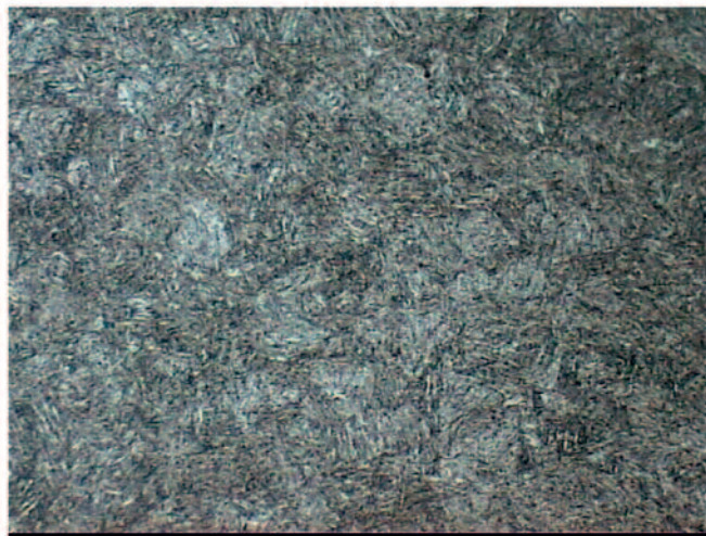
Figura 21 – Microstruttura al cuore (x500)
