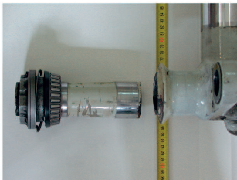
Figura 3– particolare zona rottura assale
