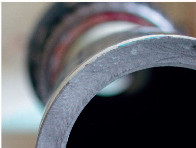
Figura 6 – particolare superficie di rottura, area B. Presenza di chevron marks
