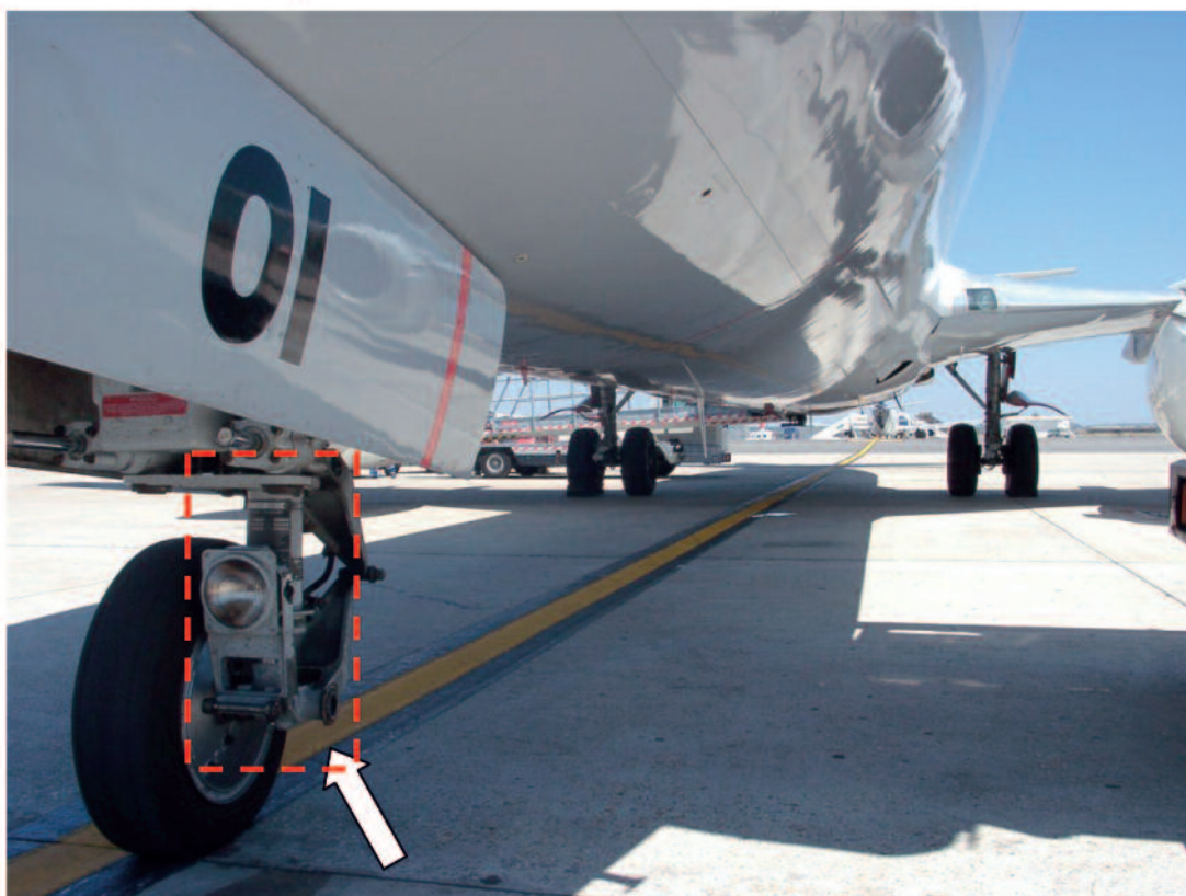
Figura 1– Rottura assale, come rilevata su campo
