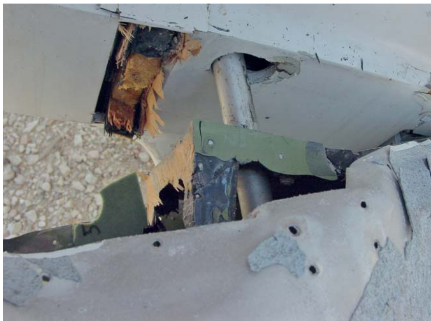
Foto n. 9: rottura longherone semiala sinistro.
