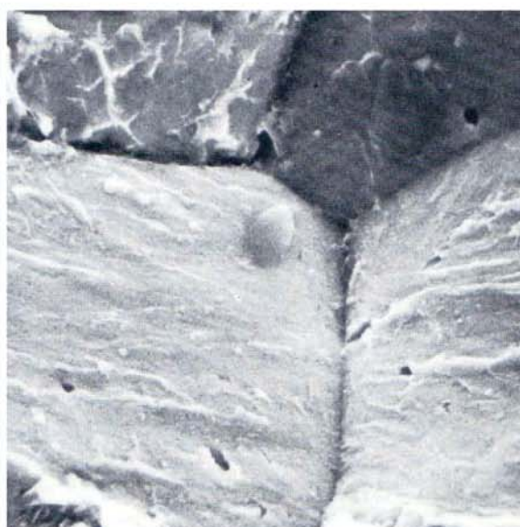
Figura 13 – Infragilimento da idrogeno di un acciaio campione (2200 x)
