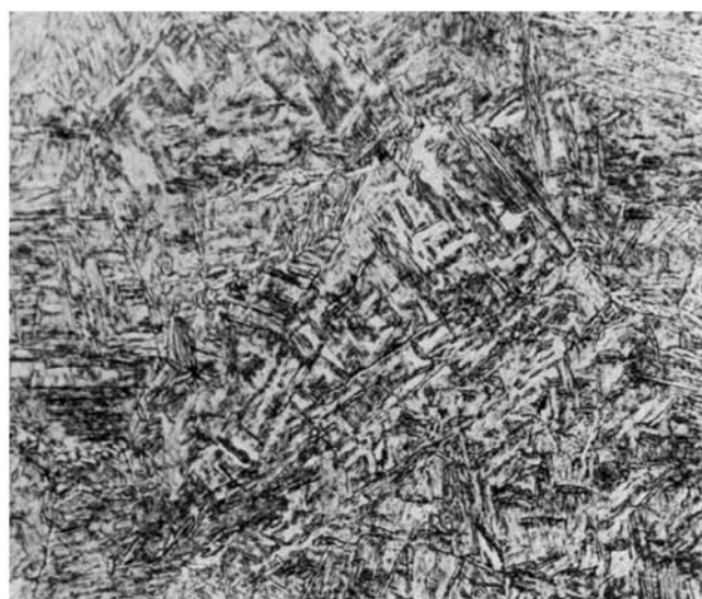
Figura 21 – acciaio campione infragilito da idrogeno (310 x)
