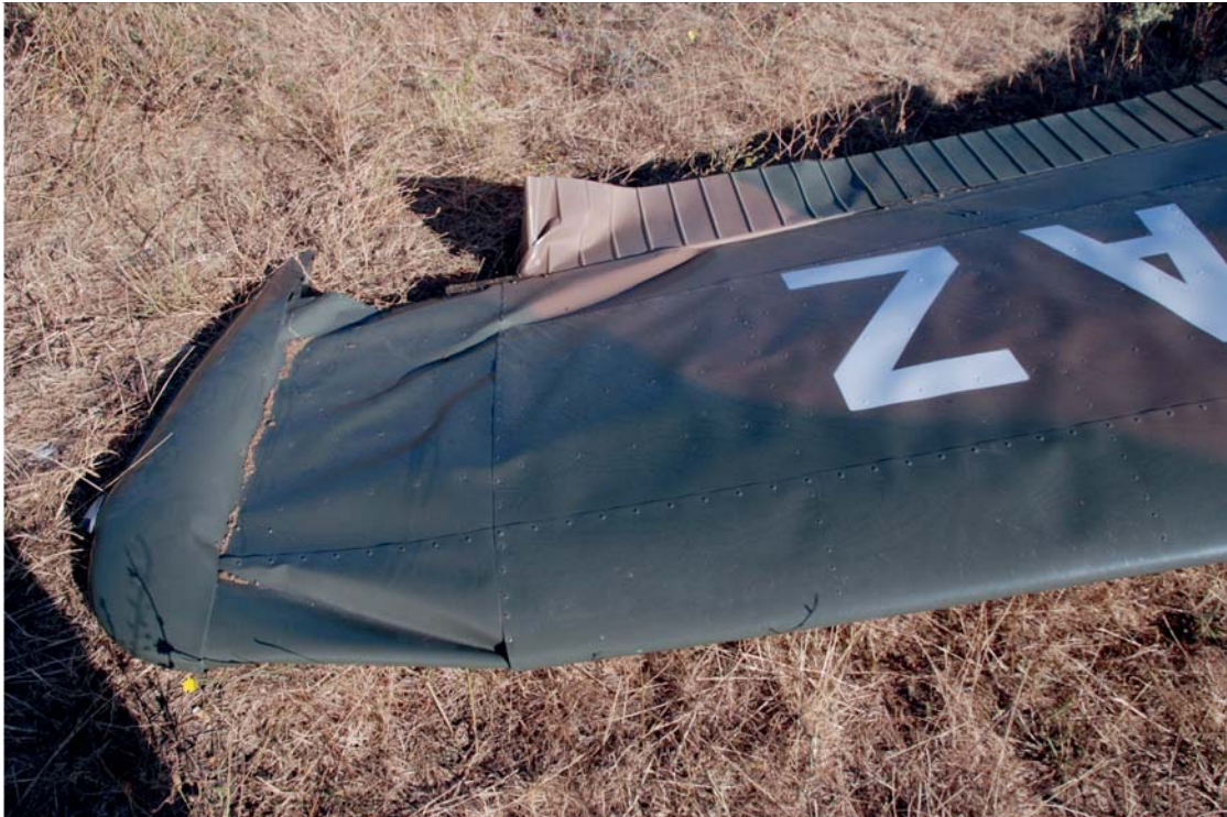
Semiala destra danneggiata.
