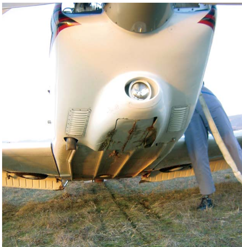
Notare la mancata fuoriuscita del carrello di atterraggio.
