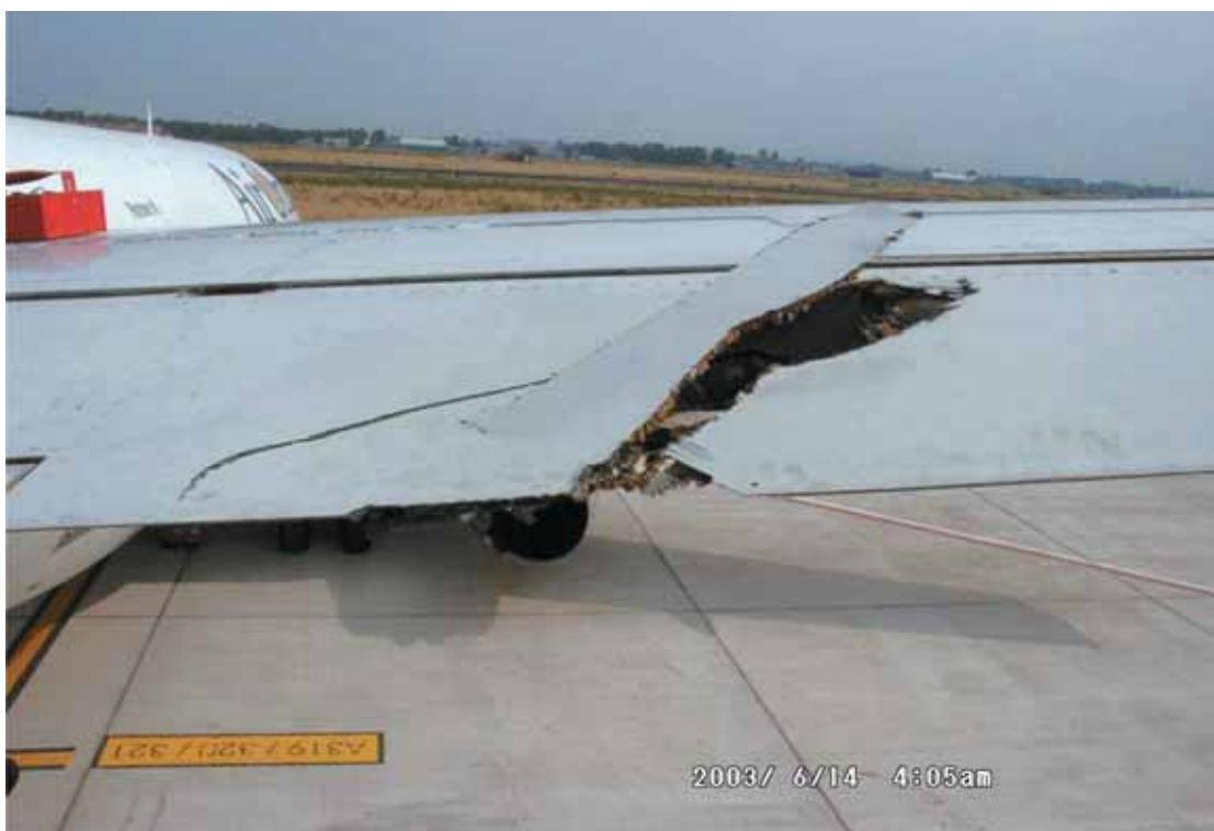
Danni all'elevatore posteriore destro del B737 I-JETC.
