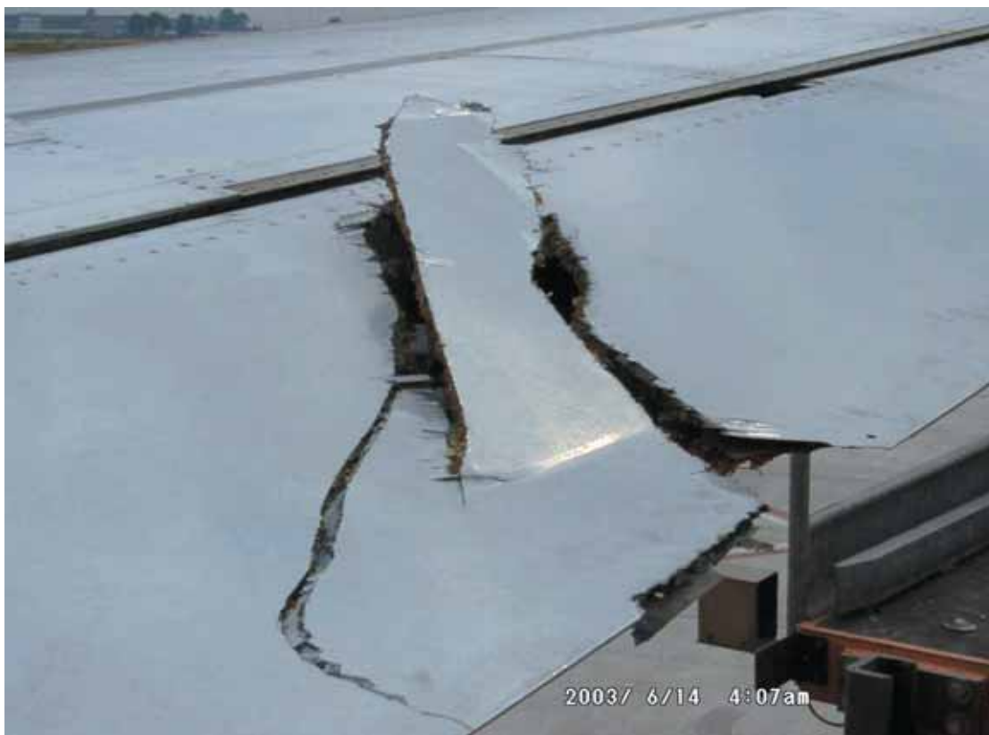
Danni all'elevatore posteriore destro del B737 I-JETC.
