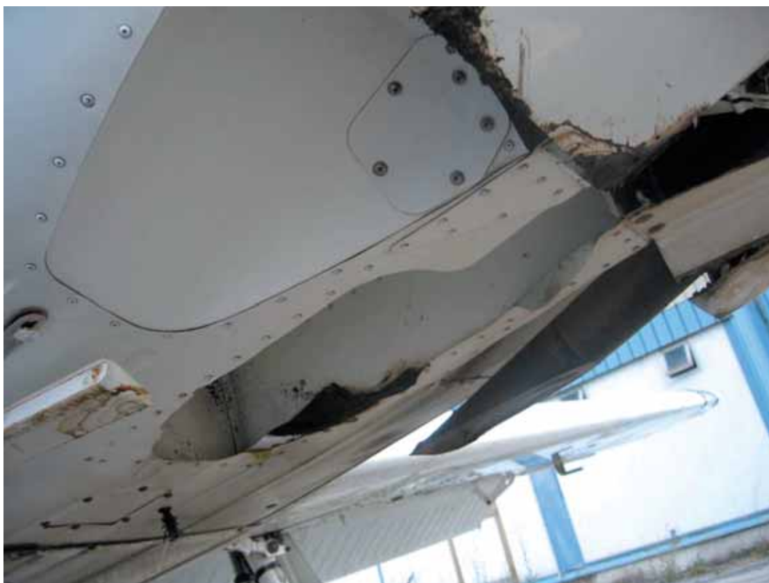
Danni al rivestimento ventrale dell'aeromobile.
