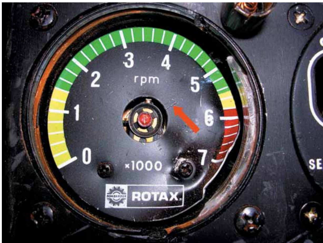
Foto n. 11: impronta su indicatore giri motore.
