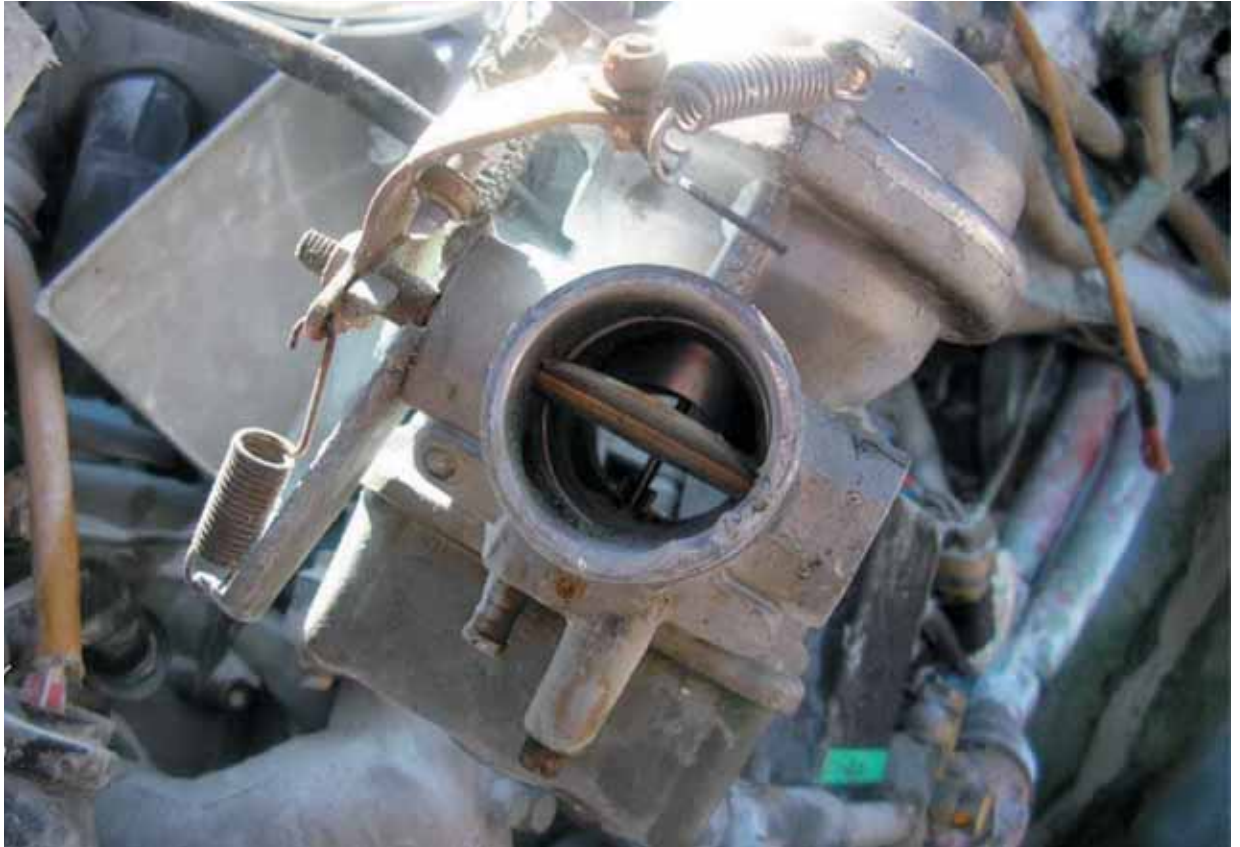
Foto n. 12: valvola del carburatore in posizione di massima apertura.
