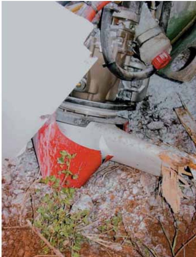
Foto n. 10: dettaglio tronconi elica rimasti solidali al motore.
