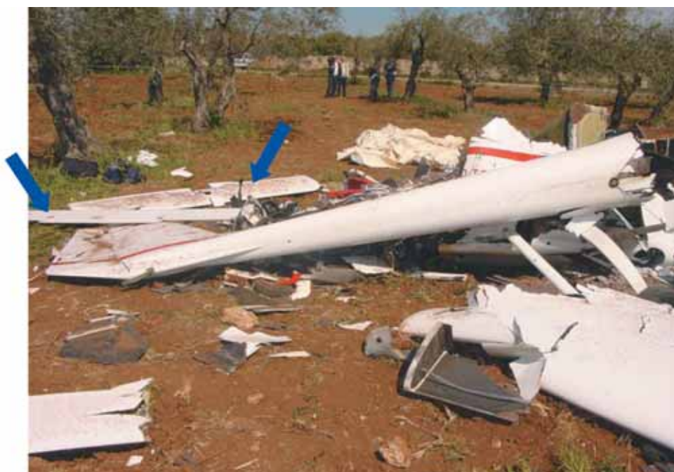
Foto n. 3: tronco di coda, stabilizzatore ed equilibratore (freccette blu) pressoché integri.
