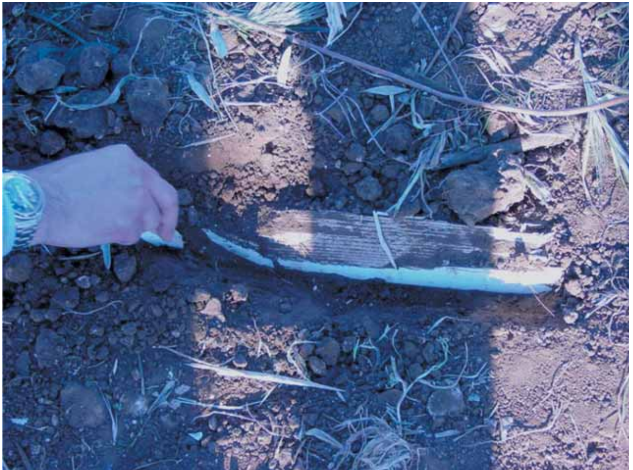
Foto n. 6: frammento elica conficcato nel terreno.
