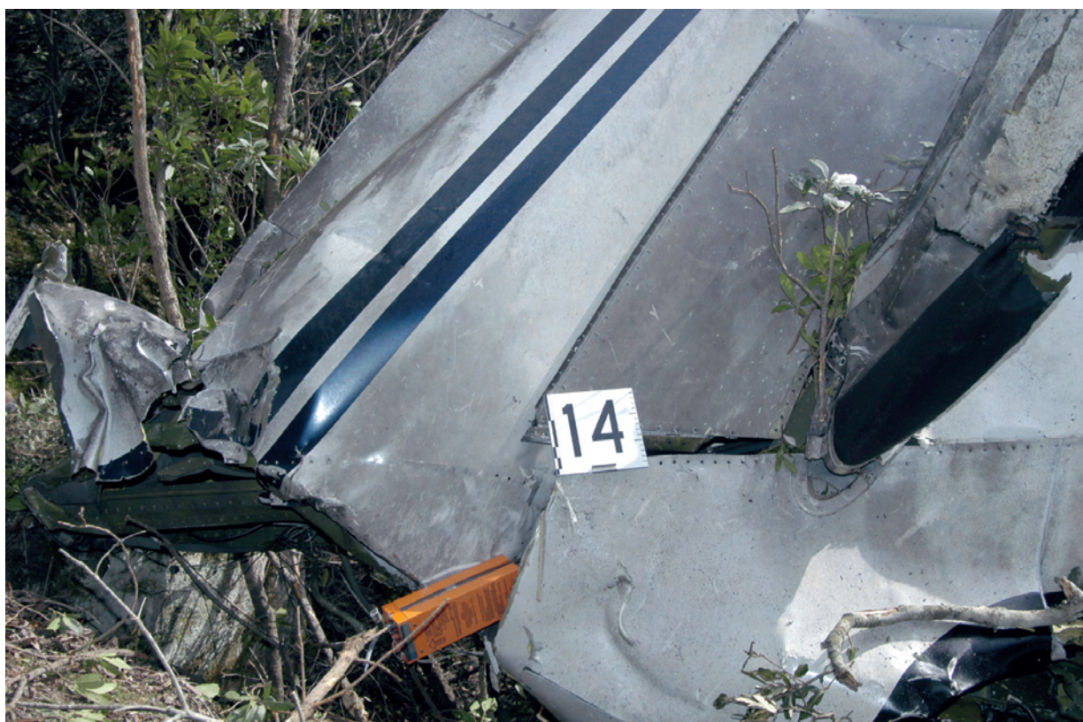
Foto n. 30: apparato ELT tra i rottami del troncone di coda.
