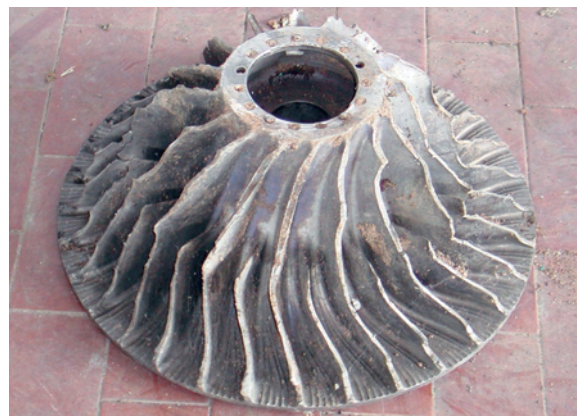
Foto n. 17: motore destro, girante del compressore.
