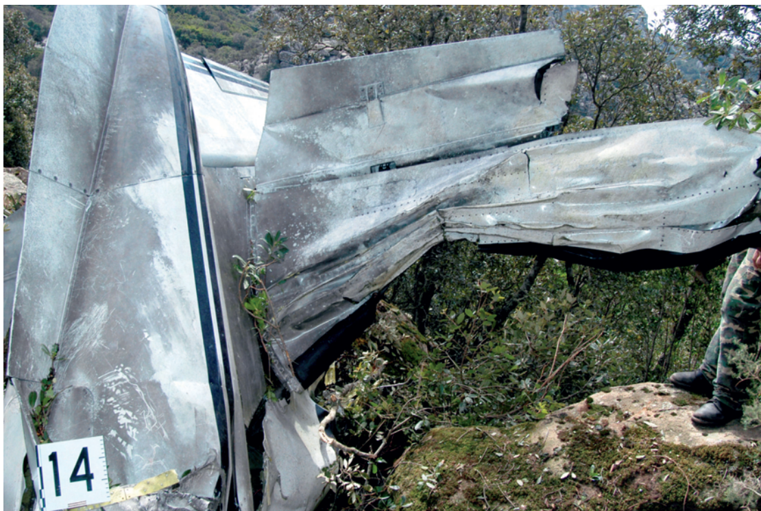
Deformazione da urto del piano di coda orizzontale destro.
