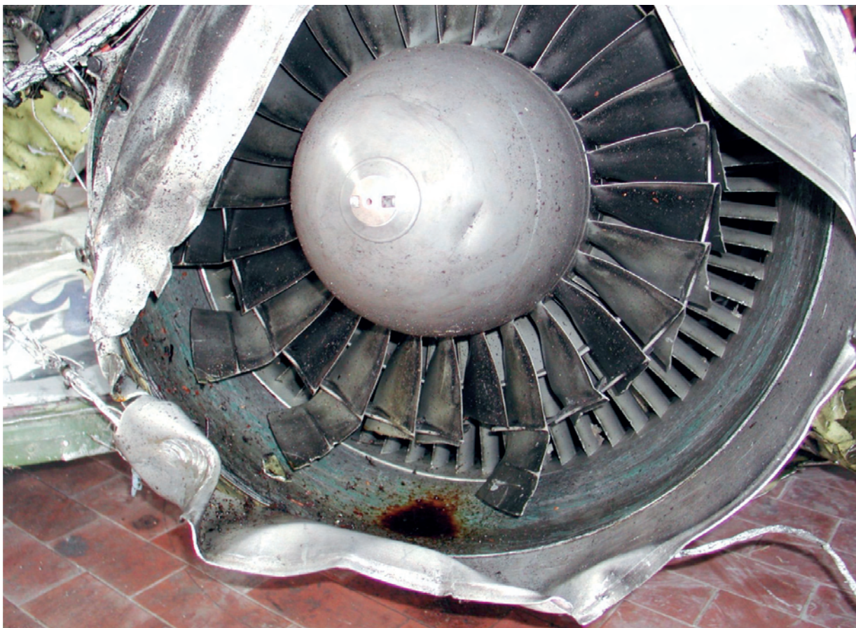
Foto n. 14: motore sinistro, danni alla palettatura rotorica del fan.
