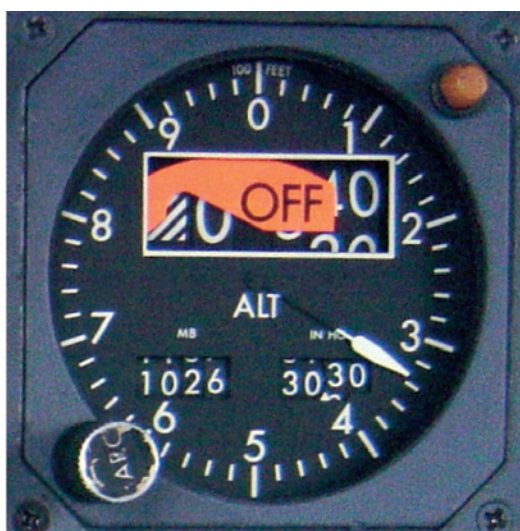
Foto n. 2: Altimeter Indicator Sperry BA-141.
