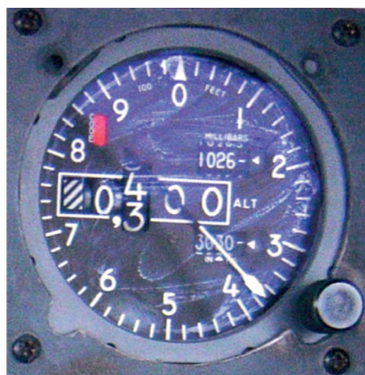
Foto n. 3: Altimeter Indicator Aerosonic.
