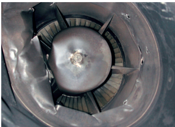
Foto n. 16: motore destro, palette rotore turbina.
