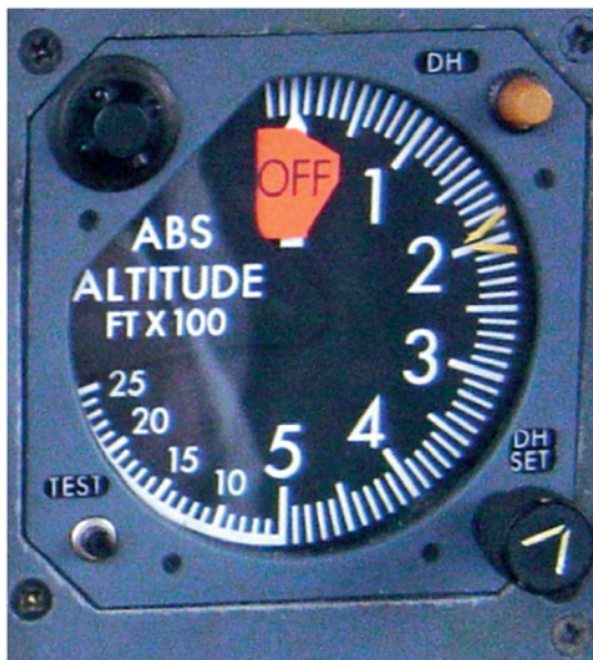
Foto n. 4 radio altimetro AA215.
