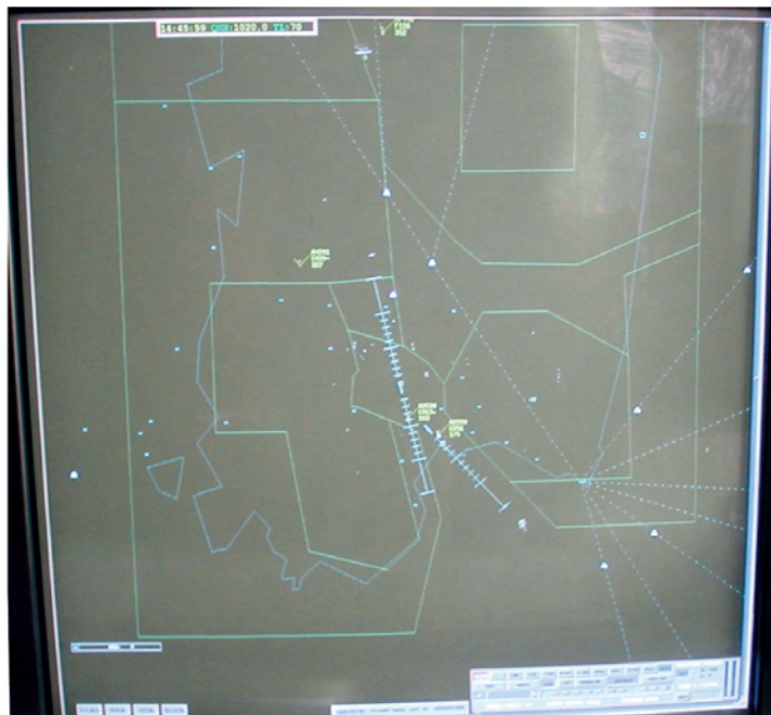
Foto n. 6: schermo radar consolle CDS 2000.
