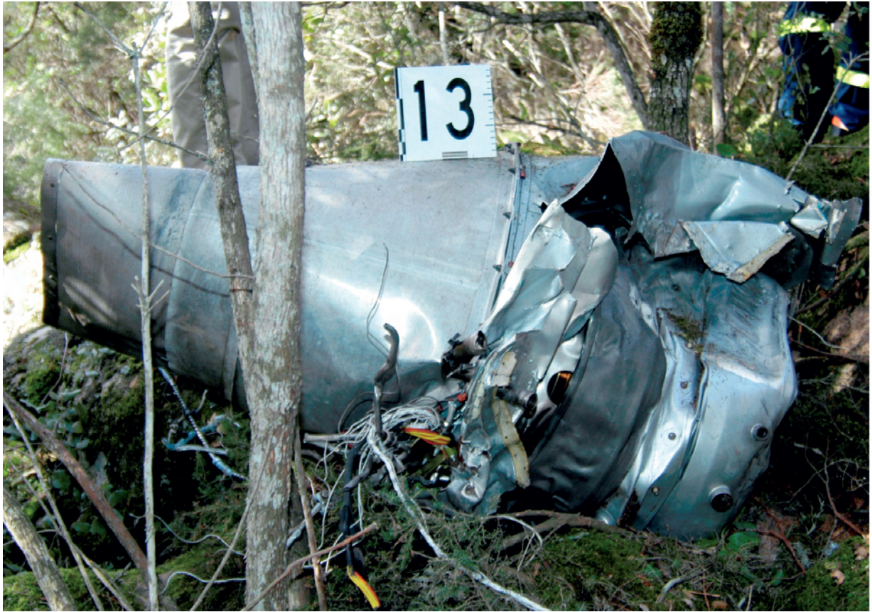
Foto n. 15: motore destro, cassa generatrice di gas e cono di scarico sul luogo dell'incidente.
