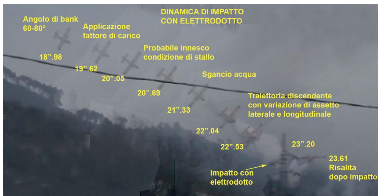
Foto n. 18: dinamica di impatto contro l'elettrodotto.
