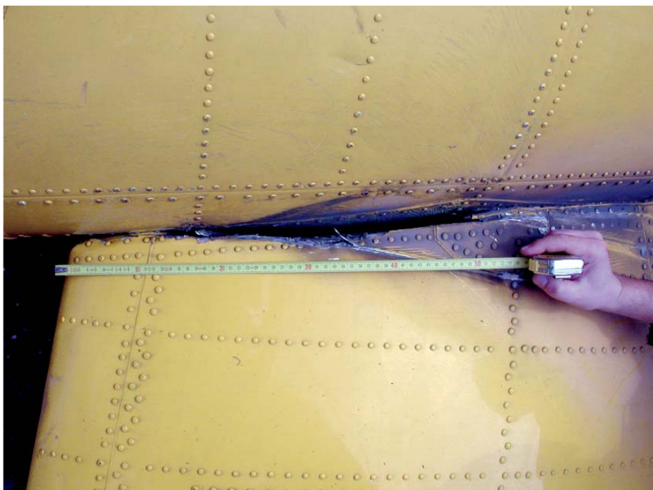
Foto n. 11: danni al galleggiante di destra.
