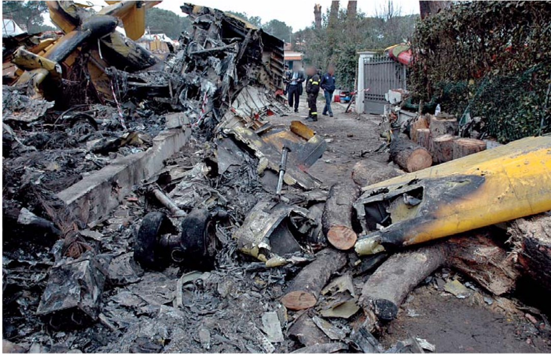
Foto n. 13: gli effetti dell'incendio propagatosi dopo l'impatto al suolo.
