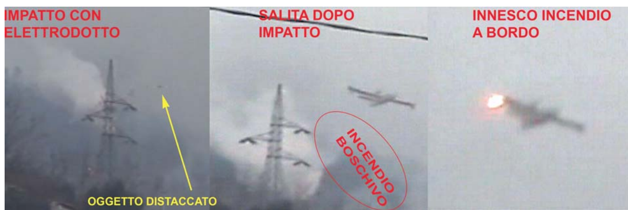
Foto n. 16: sequenza di impatto cavo e incendio a bordo.
