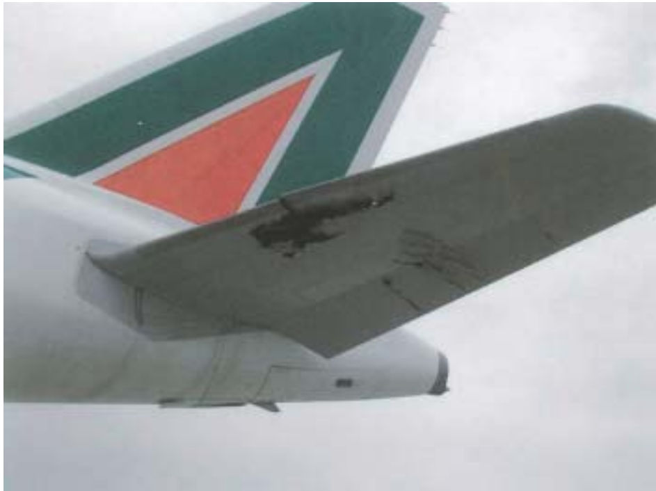
Danni dell'aeromobile; stabilizzatore sinistro
