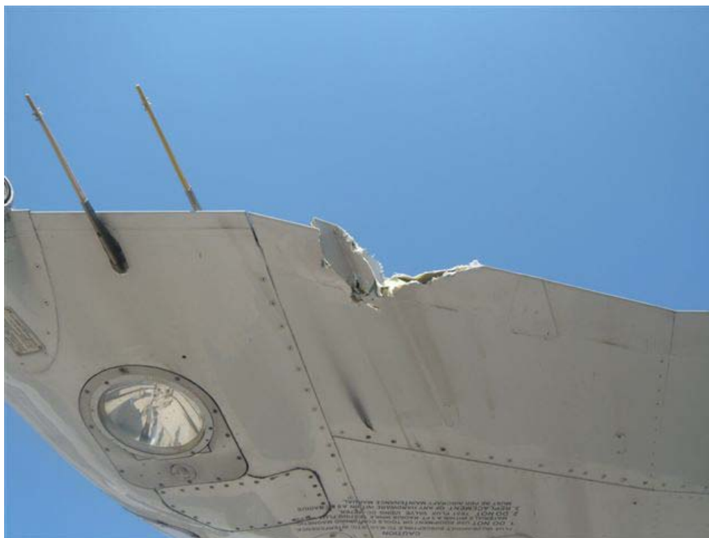
Foto 2: particolare del danneggiamento della semiala sinistra.
