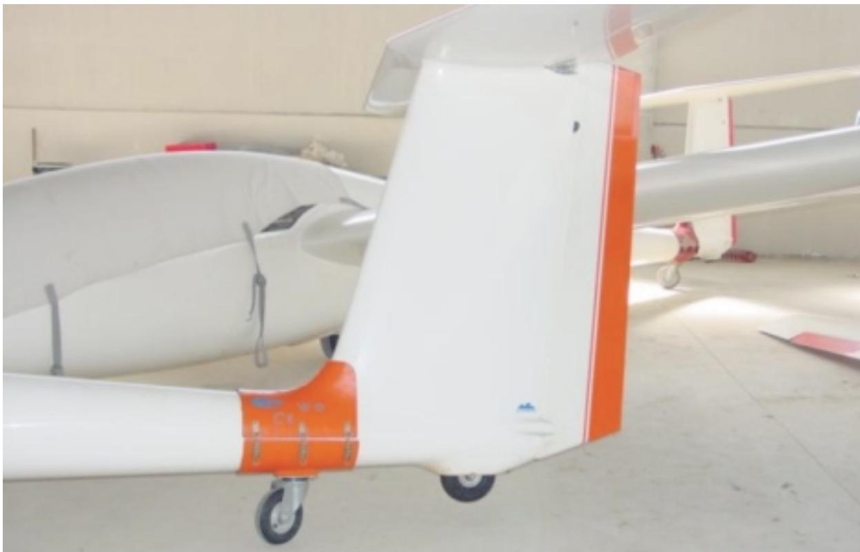
Fotografia di un ASK 21 con ruotino per la movimentazione a terra “dolly”
