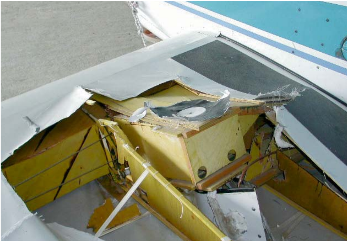
Velivolo in hangar. Danni cassone alare. Vista dall'alto
