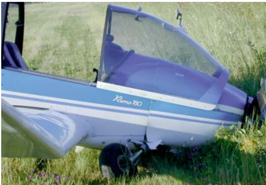
Fusoliera anteriore con gamba carrello rotta
