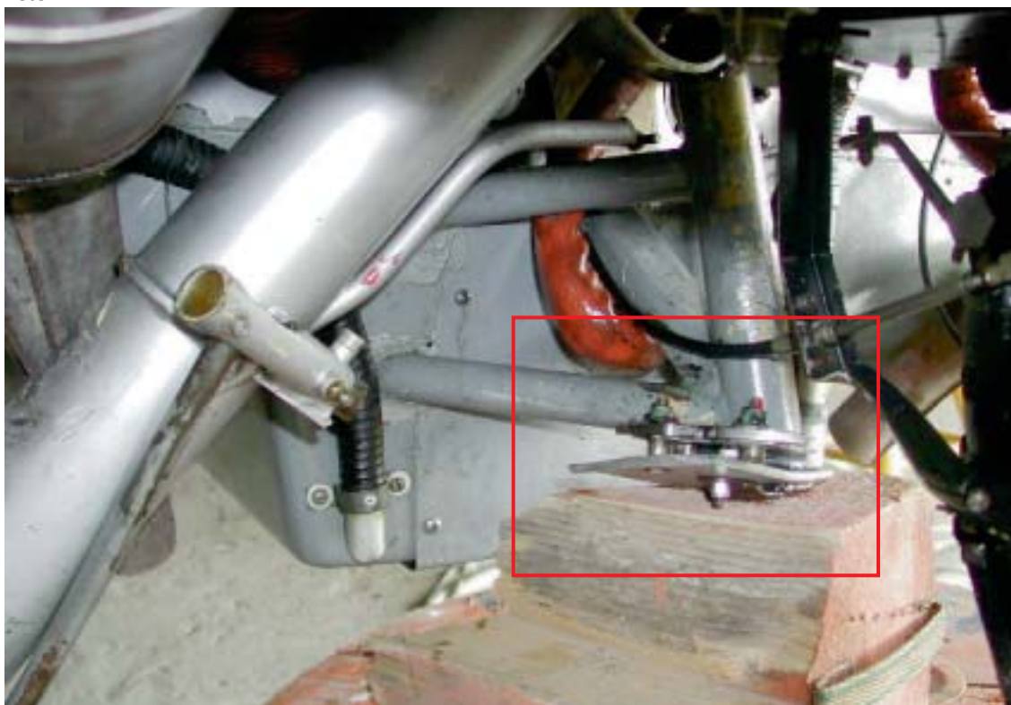
Gamba carrello anteriore. Particolare rottura piastra. Foto in hangar con punto di appoggio
