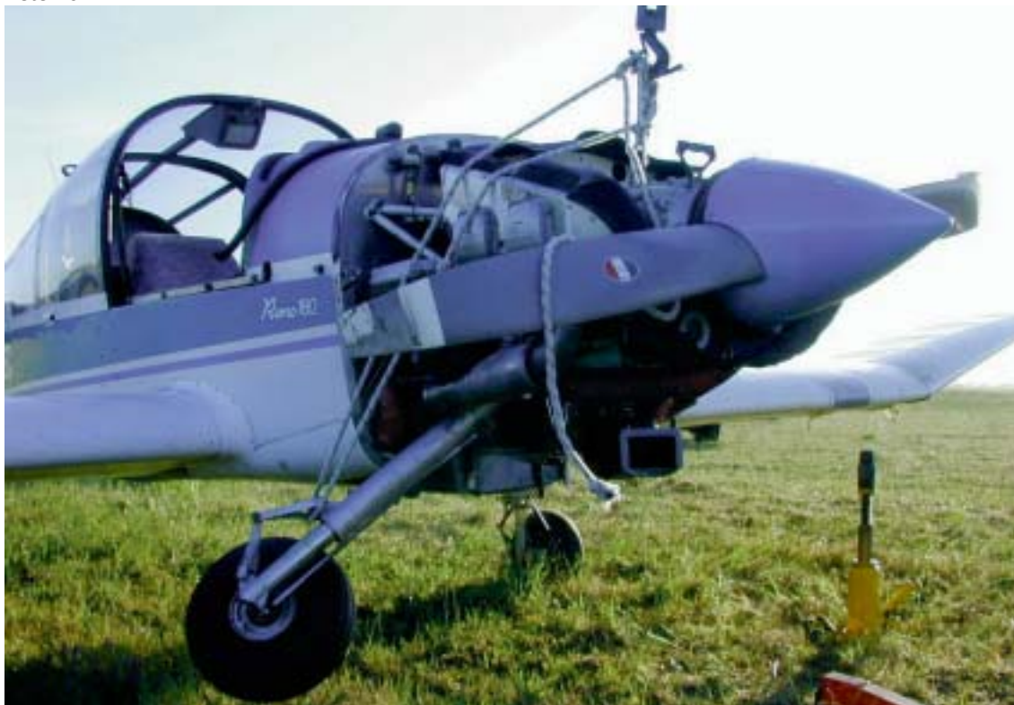
Operazioni di recupero velivolo per successivo trasporto in hangar
