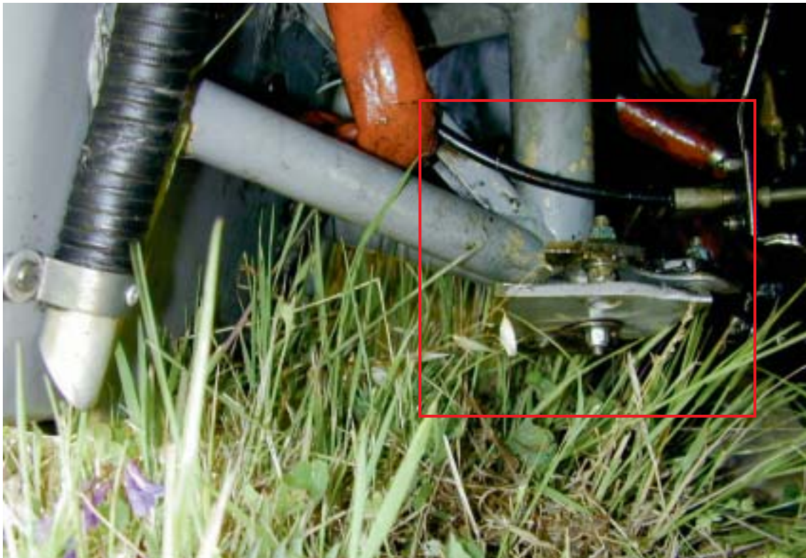
Gamba carrello anteriore. Particolare rottura piastra
