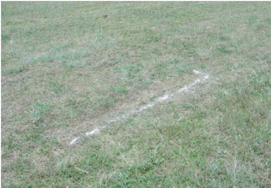
Segni impatto ruota carrello principale (particolare)
