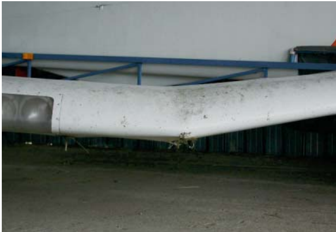
Semiala SX. Parte del bordo d'attacco che ha "strisciato" al suolo durante corsa di decelerazione
