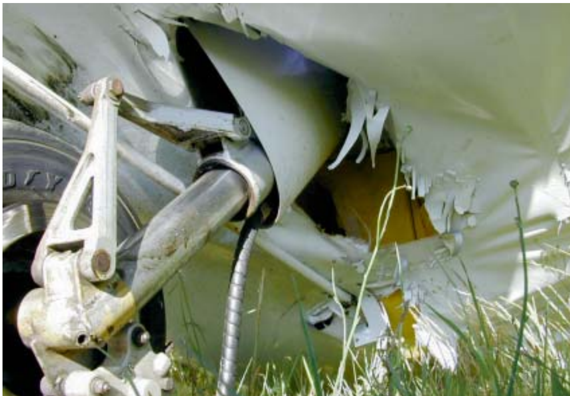
Gamba carrello principale SX. Particolare danni
