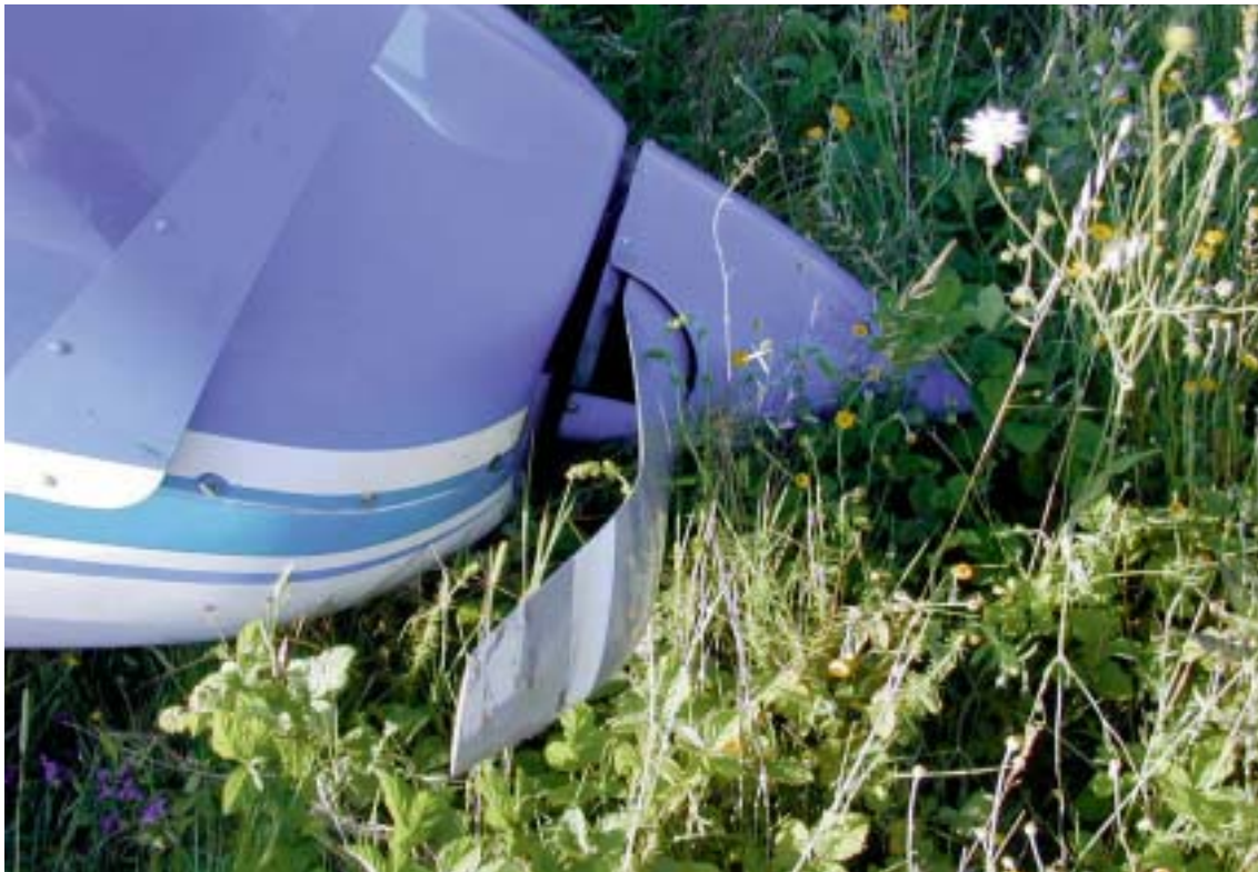
Particolare danni elica
