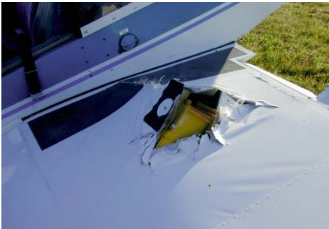
Danno cassone alare SX. Vista dall'alto
