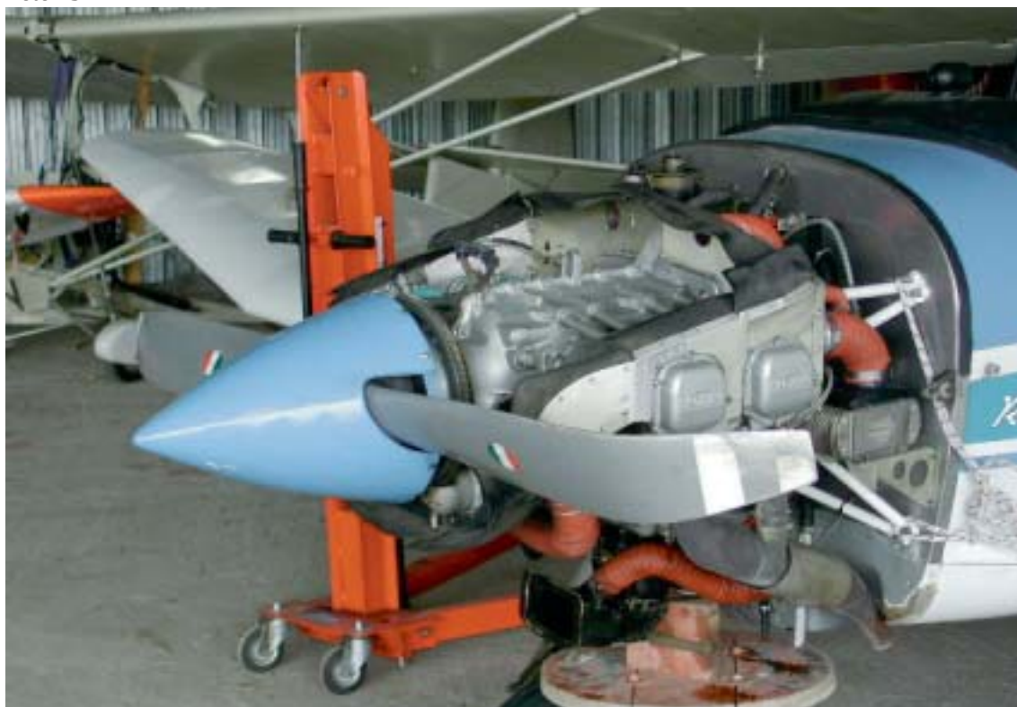
Velivolo ricoverato in hangar. Vista frontale. Notare danni estremità elica
