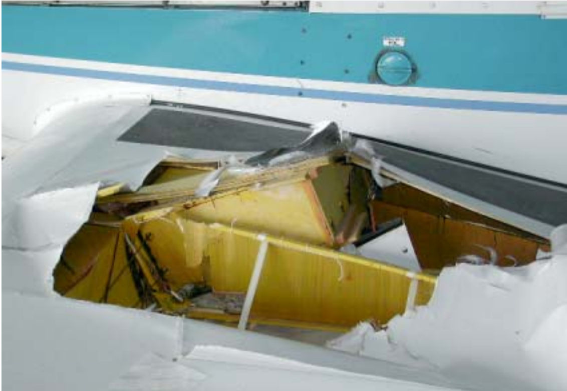
Velivolo in hangar. Danni cassone alare (particolare)
