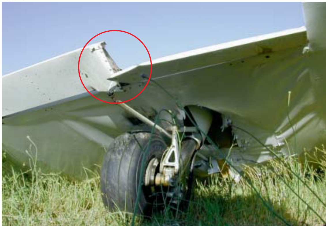
Gamba carrello SX. Notare danni alettone e flaps
